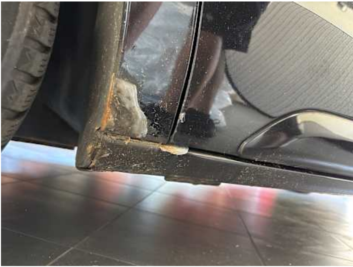
Schweller links (Rost)
