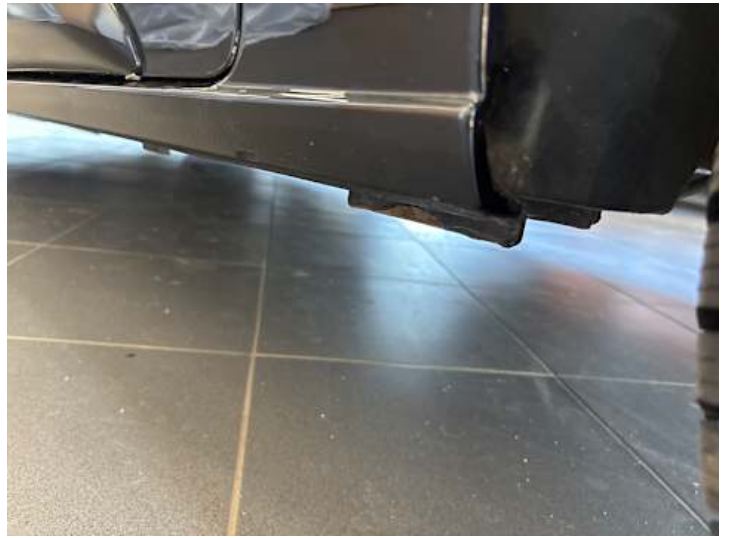
Schweller links (Rost)
