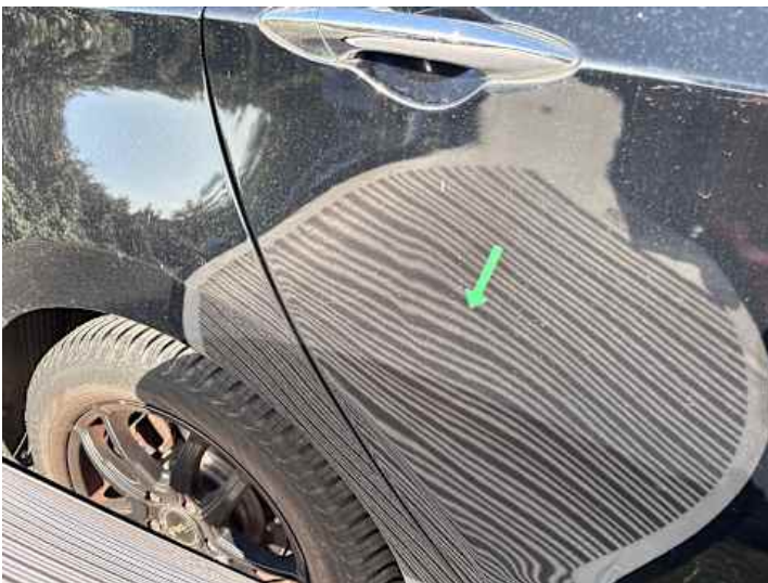
Türe hinten rechts (Unsachgemäß instand gesetzt)
