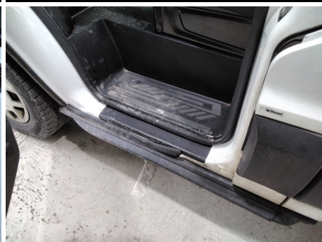
Dichtung Türeinstieg / Vorne Links / Gebrochen
