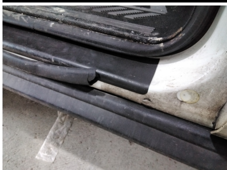
Dichtung Türeinstieg / Vorne Links / Gebrochen
