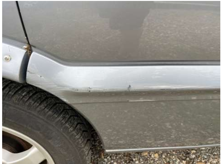
Türe hinten rechts (Kratzer, Lackschaden)
