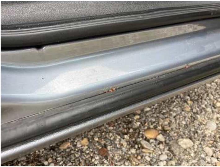
Schweller rechts (Rost, Lackschaden)
