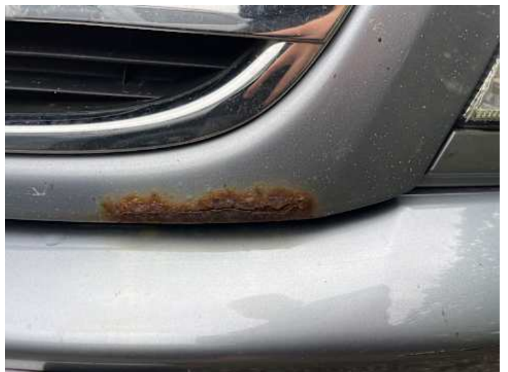
Motorhaube (Lackschaden, Rost)
