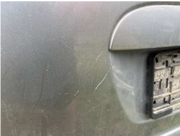
Heckklappe (Kratzer, Lackschaden, Delle)
