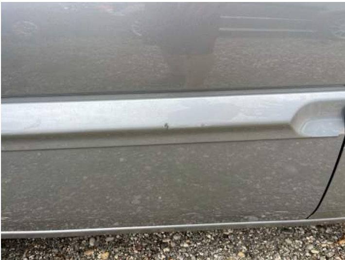
Türe hinten rechts (Kratzer, Lackschaden)
