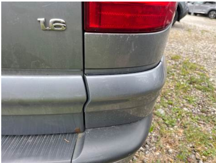
Stoßstange hinten (Riss/Bruch, Spaltmaße ungenau)
