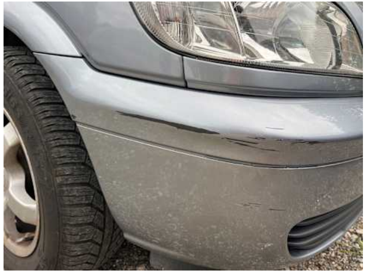
Stoßstange vorne (Kratzer, Lackschaden)
