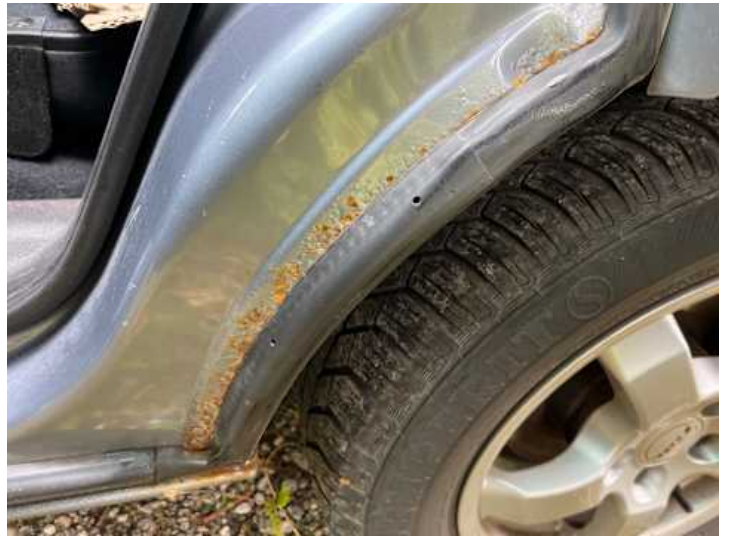
Seitenteil hinten links (Lackschaden, Rost)
