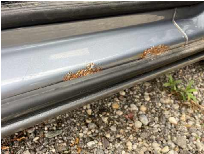
Schweller rechts (Rost, Lackschaden)
