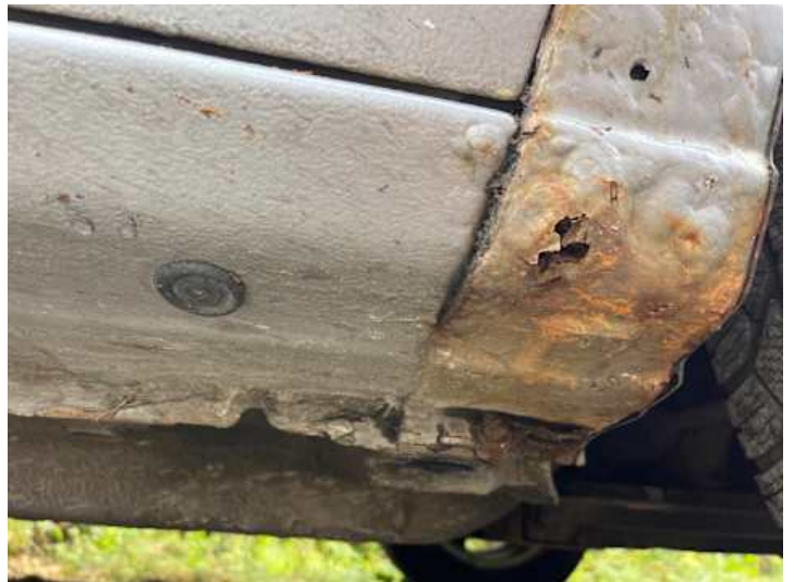
Schweller rechts (Rost, Lackschaden)
