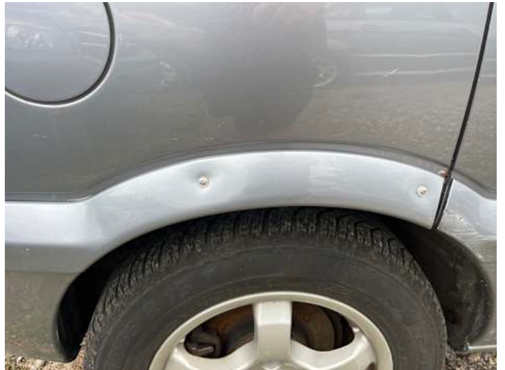
Seitenteil hinten rechts (Unsachgemäß instand gesetzt, Lackschaden)
