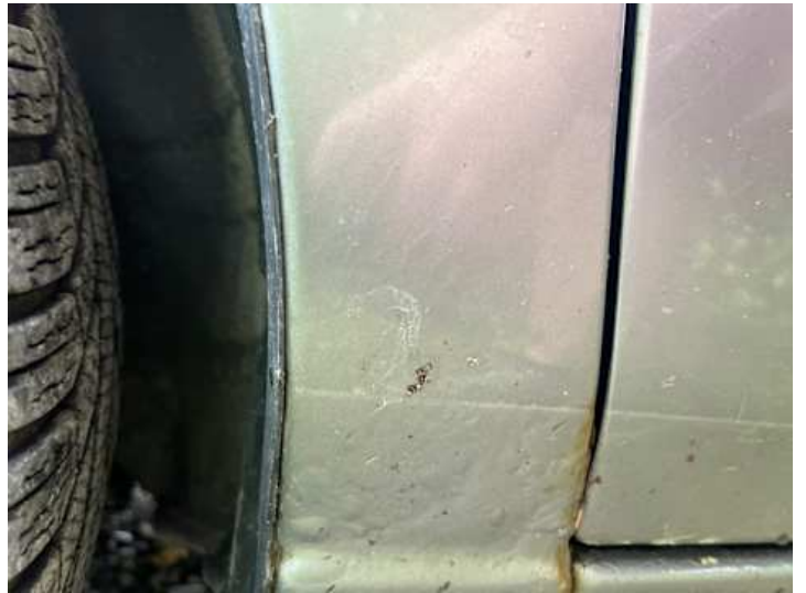
Kotflügel vorne links (Lackschaden, Rost)
