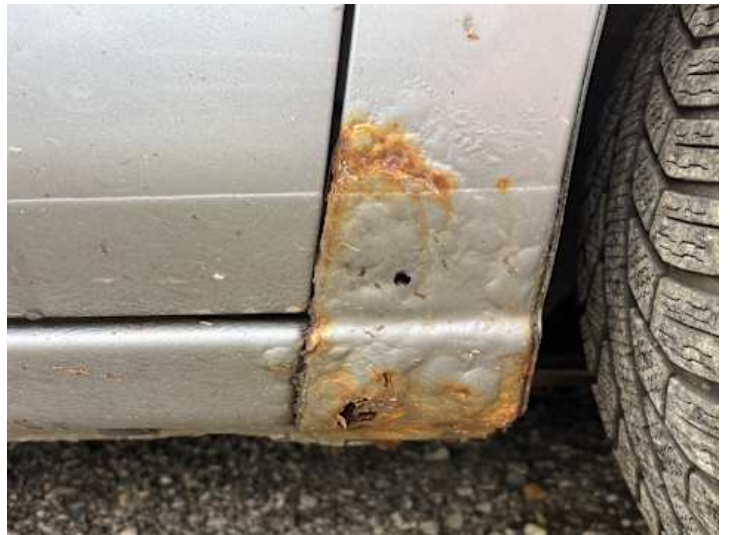
Kotflügel vorne rechts (Lackschaden, Rost)
