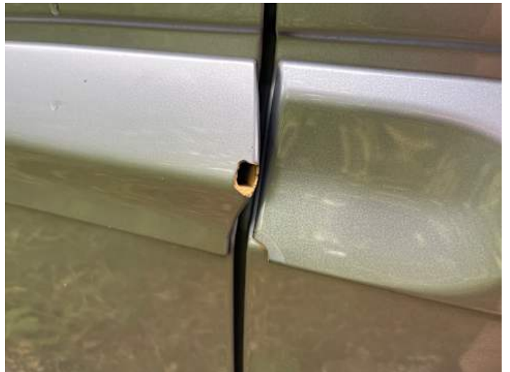
Fahrtür (Lackschaden, Riss/Bruch)
