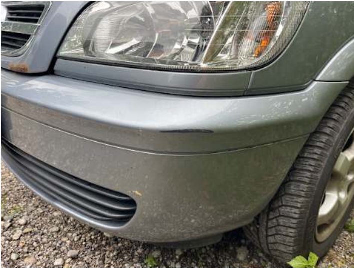
Stoßstange vorne (Kratzer, Lackschaden)
