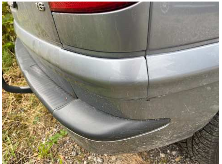
Stoßstange hinten (Riss/Bruch, Spaltmaße ungenau)
