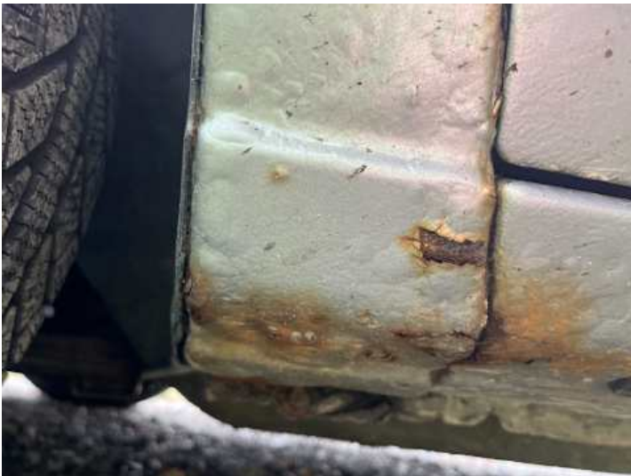
Kotflügel vorne links (Lackschaden, Rost)
