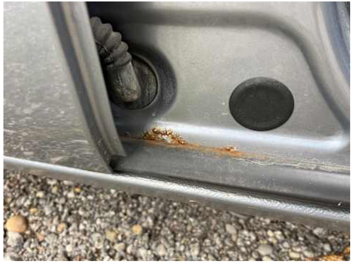
Schweller rechts (Rost, Lackschaden)
