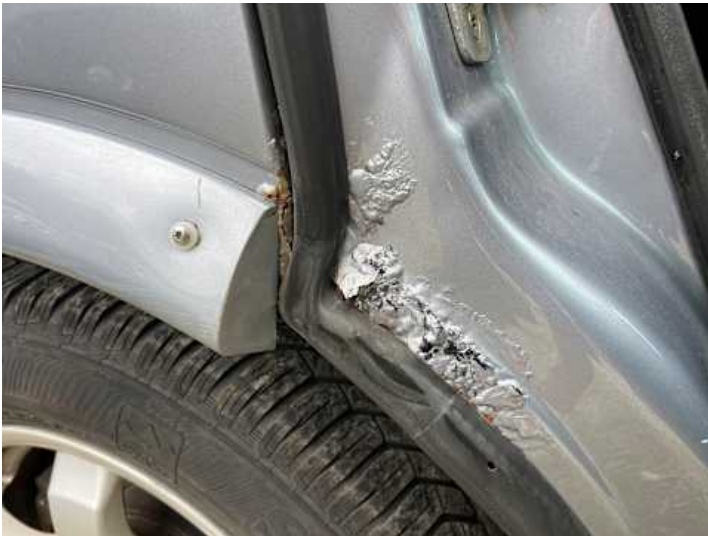
Seitenteil hinten rechts (Lackschaden, Rost)
