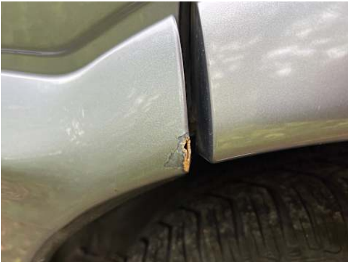
Türe hinten links (Riss/Bruch)
