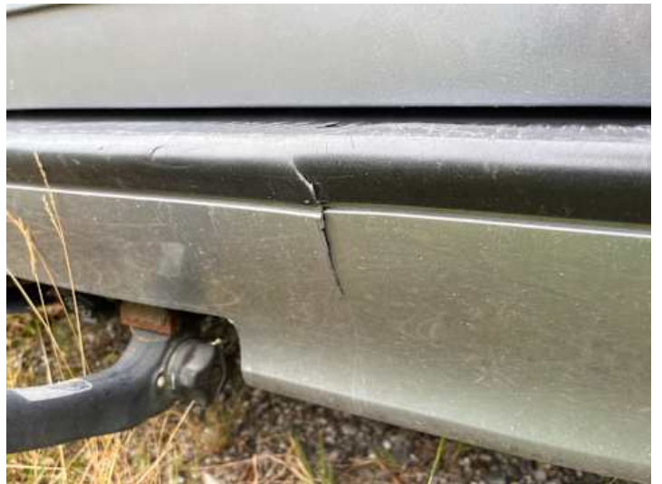
Stoßstange hinten (Riss/Bruch, Spaltmaße ungenau)
