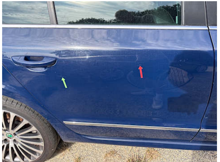
Türe hinten rechts (Kratzer)
