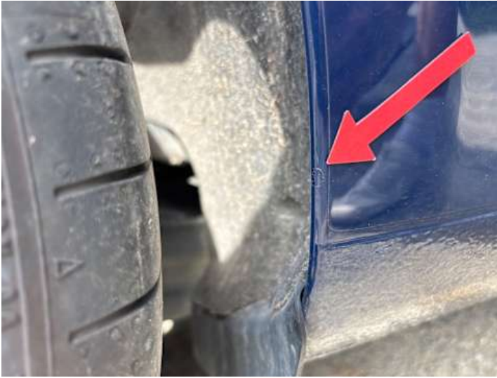
Seitenteil hinten rechts (Unsachgemäß instand gesetzt, Steinschlag)
