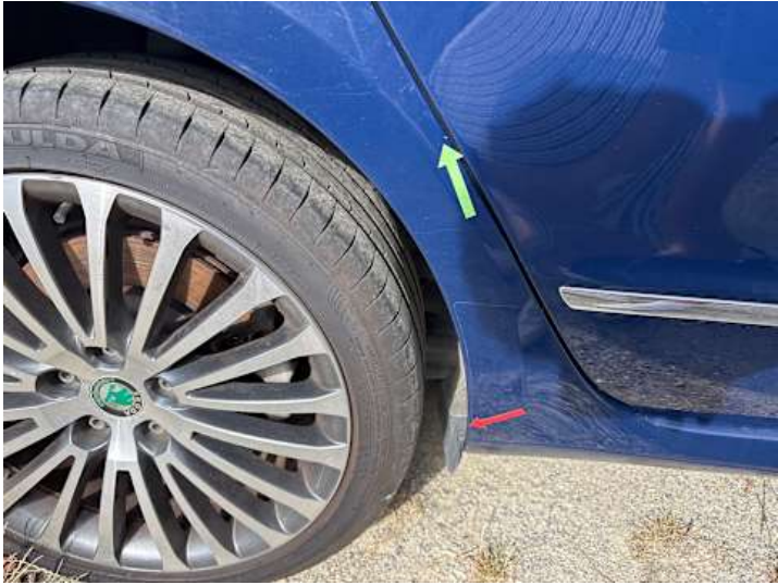
Seitenteil hinten rechts (Unsachgemäß instand gesetzt, Steinschlag)
