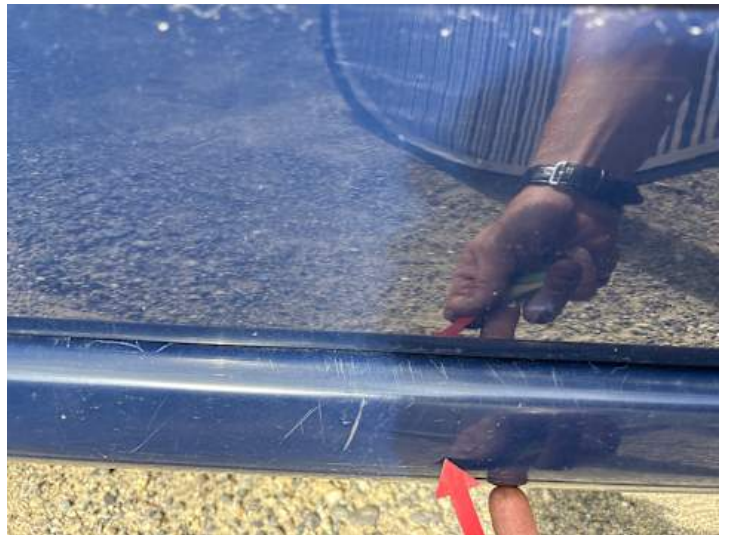
Schweller rechts (Kratzer)
