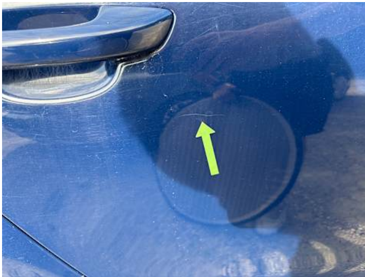
Türe hinten rechts (Kratzer)
