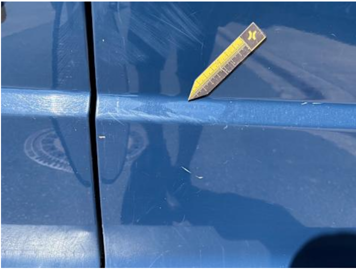
Heckklappe (Kratzer, Rost)
