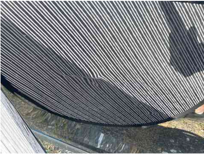
Türe hinten rechts (Verformung)
