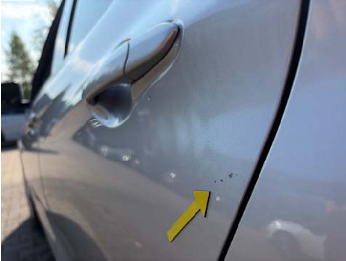
Türe hinten links (Steinschlag)
