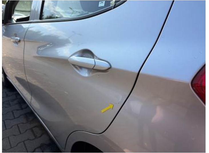
Türe hinten links (Steinschlag)
