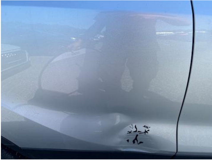
Türe hinten rechts (Verformung, Lackschaden, Kratzer, Delle)
