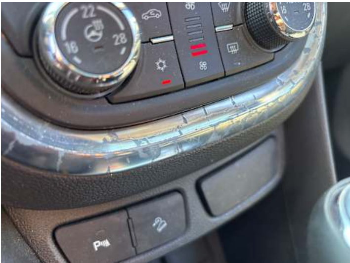
Innenraum (Diverse Schäden)
