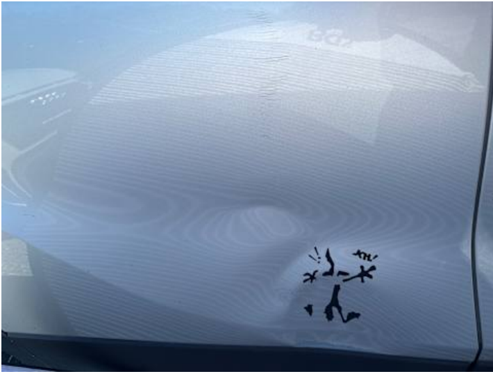
Türe hinten rechts (Verformung, Lackschaden, Kratzer, Delle)
