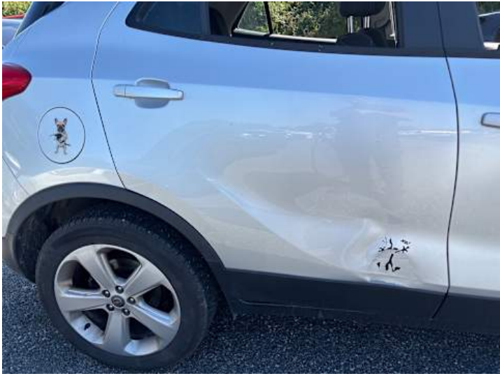
Türe hinten rechts (Verformung, Lackschaden, Kratzer, Delle)
