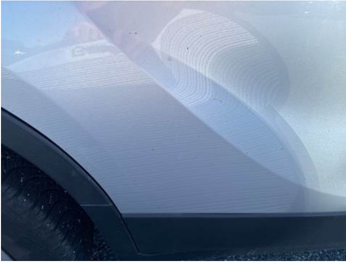
Türe hinten rechts (Verformung, Lackschaden, Kratzer, Delle)
