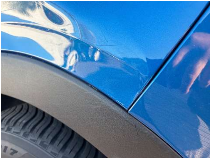
Seitenteil hinten links (Verformung, Lackschaden)
