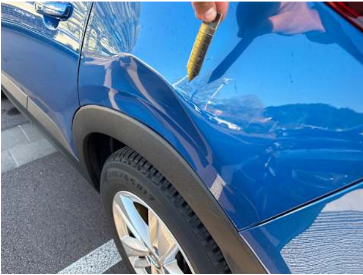
Seitenteil hinten links (Verformung, Lackschaden)
