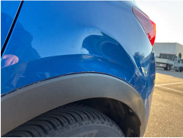
Seitenteil hinten links (Verformung, Lackschaden)
