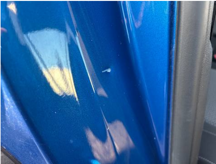
Schweller rechts (Lackschaden, Delle)
