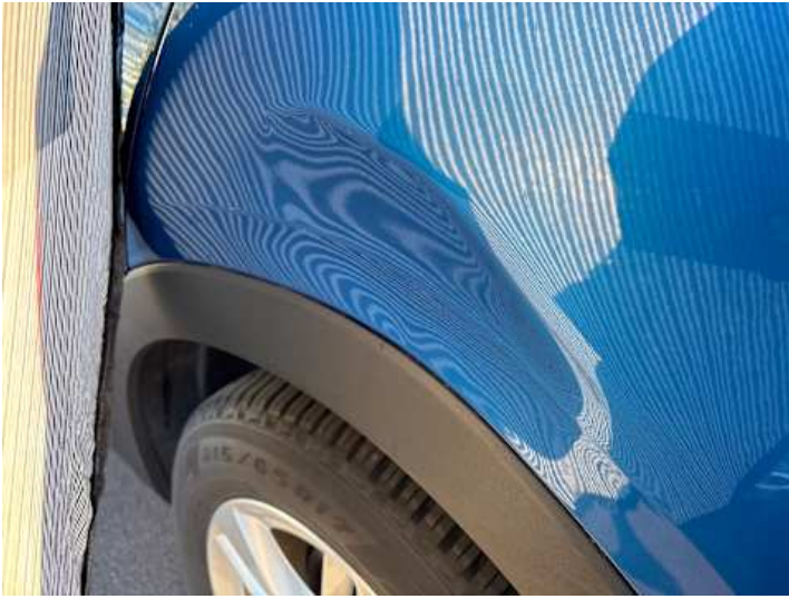
Seitenteil hinten links (Verformung, Lackschaden)
