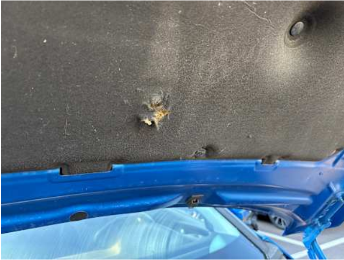
Motorhaube (Anderer Schaden): Dämmung
