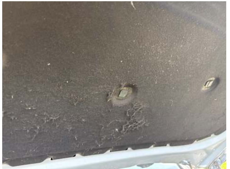
Motorhaube (Anderer Schaden): Dämmung leicht beschädigt
