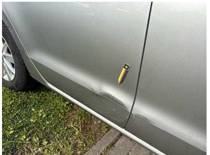
Türe hinten rechts (Verformung)
