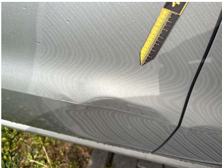
Türe hinten rechts (Verformung)
