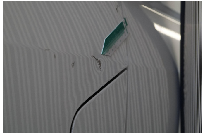
Bild 16: Außen, Tür vorne links, eingedellt/verschrammt, smart repair
