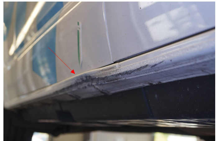
Bild 10: Außen, Seitenschweller rechts, deformiert, instandsetzen und lackieren mit Lackaufbau
