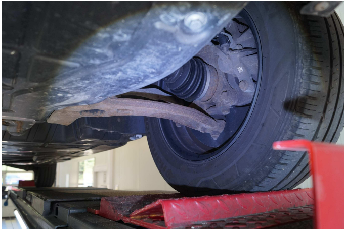
Bild 5: Technik, Bodengruppe und Achsteile, beginnende Korrosion, Gebrauchsspur
