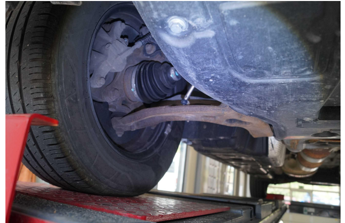
Bild 6: Technik, Bodengruppe und Achsteile, beginnende Korrosion, Gebrauchsspur
