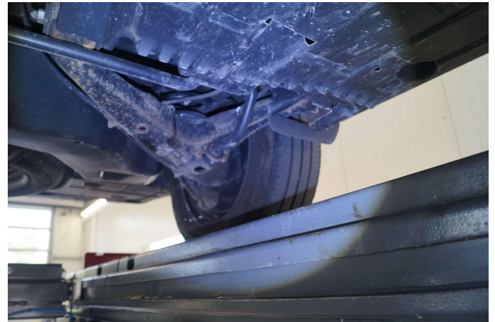
Bild 8: Technik, Bodengruppe und Achsteile, beginnende Korrosion, Gebrauchsspur
