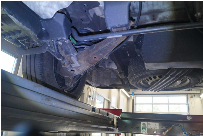
Bild 7: Technik, Bodengruppe und Achsteile, beginnende Korrosion, Gebrauchsspur
