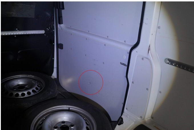
Bild 3: Innen, Verkleidung Schiebetür rechts, zerbrochen, erneuern
