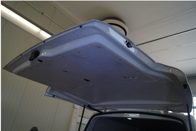
Bild 1: Innen, Verkleidung Heckklappe, gerissen, erneuern
