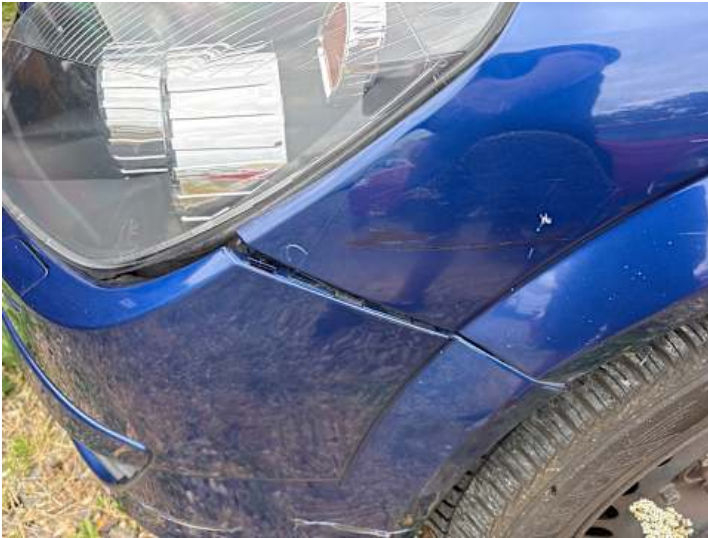
Stoßstange vorne (Spaltmaße ungenau, Lackschaden, Verformung)
