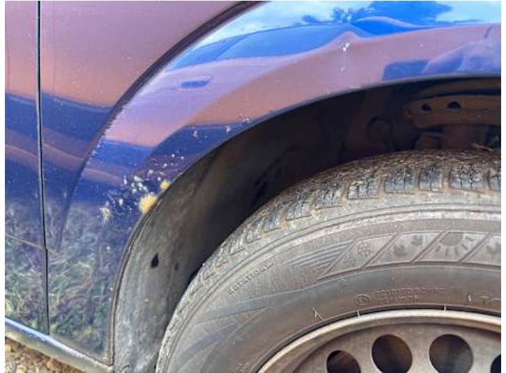
Kotflügel vorne rechts (Rost, Delle)
