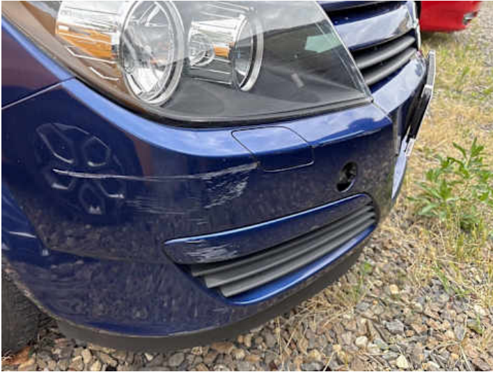
Stoßstange vorne (Spaltmaße ungenau, Lackschaden, Verformung)
