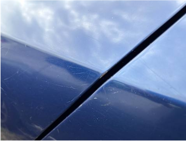
Türe hinten links (Kratzer, Rost)
