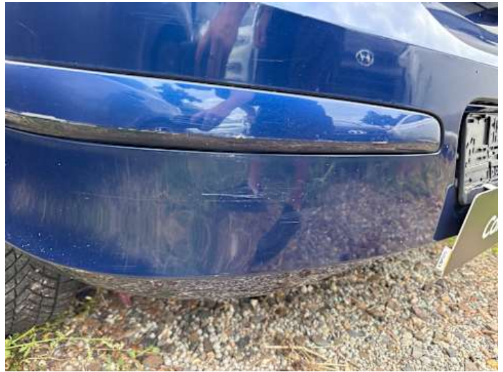
Stoßstange hinten (Kratzer, Lackschaden)
