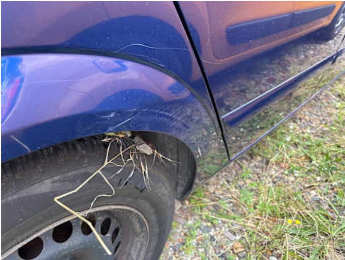
Seitenteil hinten rechts (Verformung, Kratzer, Lackschaden)
