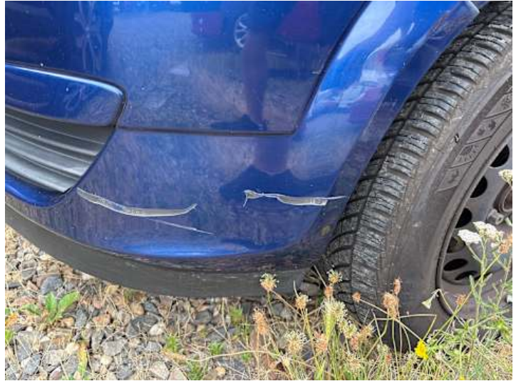
Stoßstange vorne (Spaltmaße ungenau, Lackschaden, Verformung)
