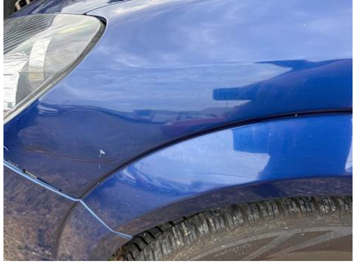
Kotflügel vorne links (Lackschaden, Verformung)
