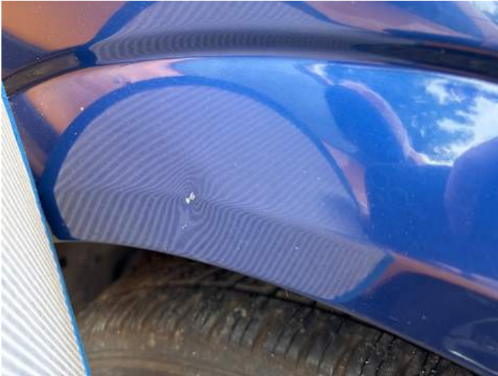
Kotflügel vorne rechts (Rost, Delle)
