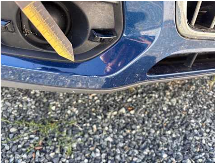
Stoßstange vorne (Verformung)
