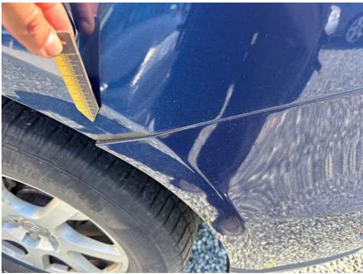
Stoßstange hinten (Spaltmaße ungenau)
