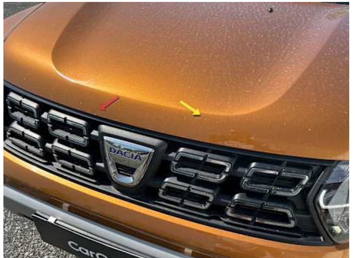
Motorhaube (Kratzer, Steinschlag, Delle)
