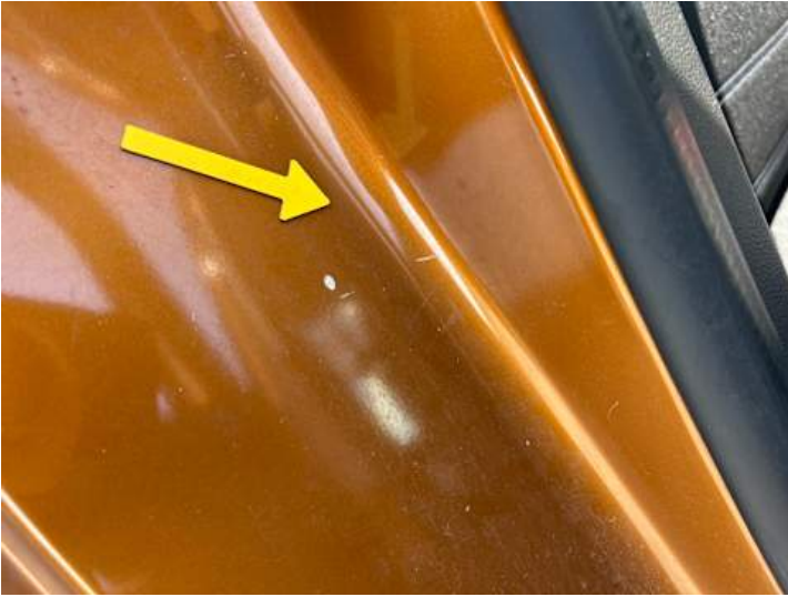
Seitenteil hinten rechts (Kratzer, Delle, Verformung)
