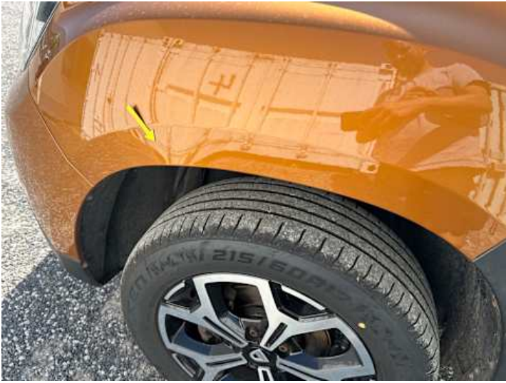
Kotflügel vorne links (Verformung)
