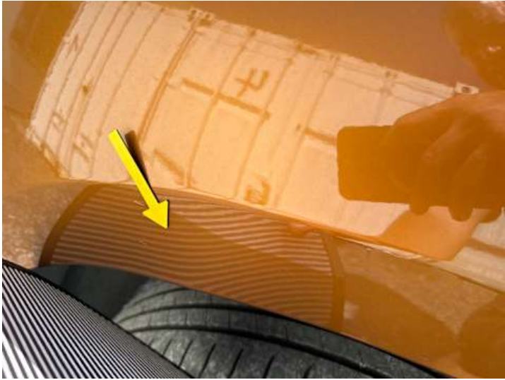
Kotflügel vorne links (Verformung)
