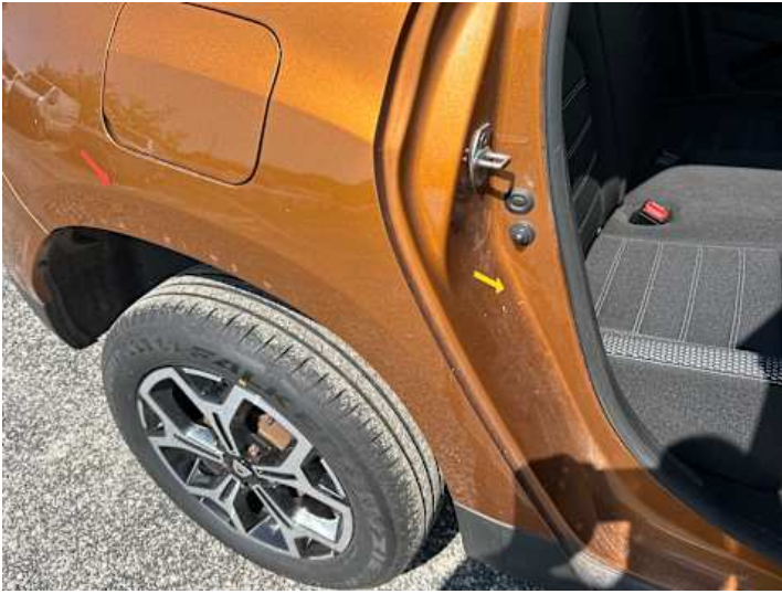
Seitenteil hinten rechts (Kratzer, Delle, Verformung)
