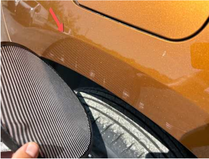
Seitenteil hinten rechts (Kratzer, Delle, Verformung)
