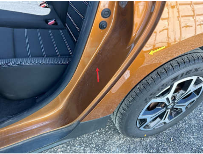
Seitenteil hinten links (Kratzer, Delle)
