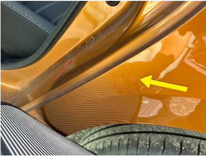
Seitenteil hinten links (Kratzer, Delle)
