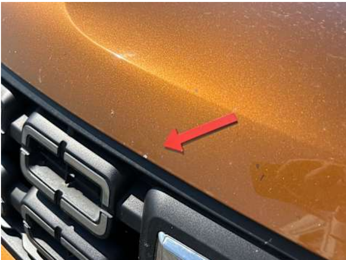
Motorhaube (Kratzer, Steinschlag, Delle)
