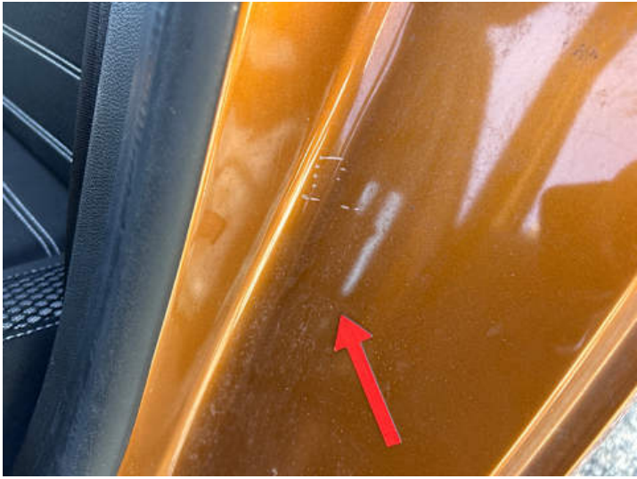
Seitenteil hinten links (Kratzer, Delle)
