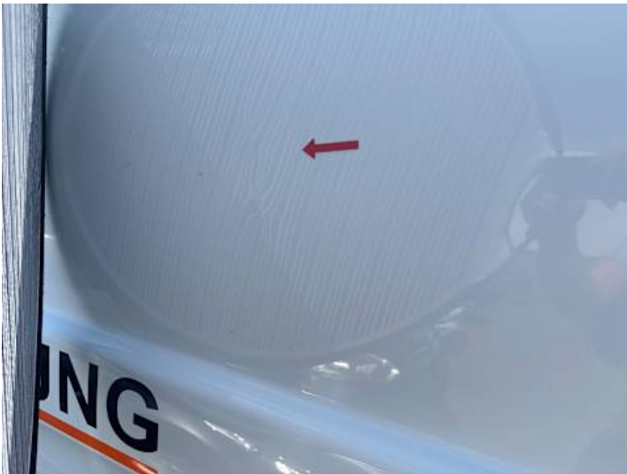
Türe hinten rechts (Verformung)
