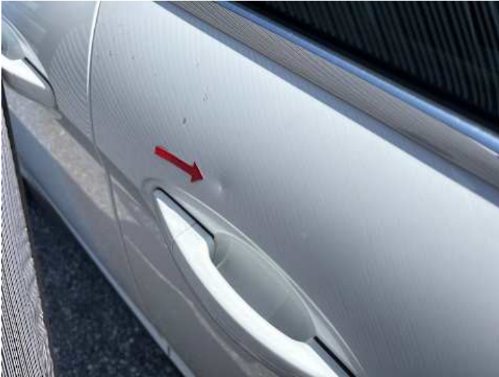
Beifahrertür (Lackschaden, Delle)
