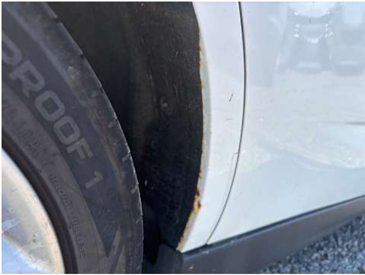
Seitenteil hinten rechts (Rost)
