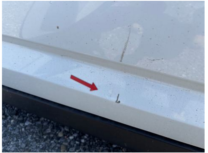
Beifahrertür (Lackschaden, Delle)
