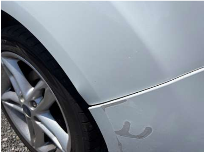
Seitenteil hinten links (Verformung, Spaltmaße ungenau)
