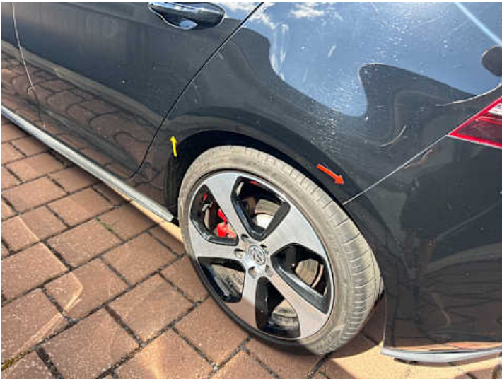
Seitenteil hinten links (Delle, Rost)
