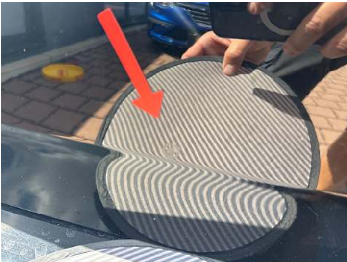
Heckklappe (Kratzer, Unsachgemäß instand gesetzt, Rost)
