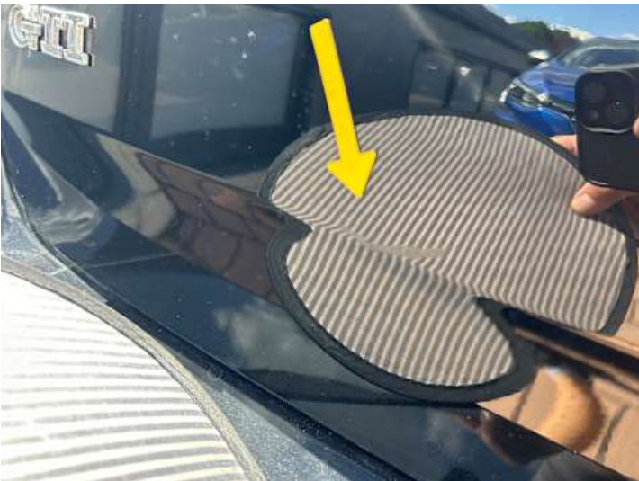
Heckklappe (Kratzer, Unsachgemäß instand gesetzt, Rost)
