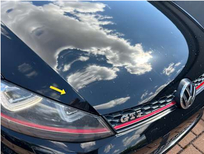
Motorhaube (Steinschlag, Unsachgemäß instand gesetzt)
