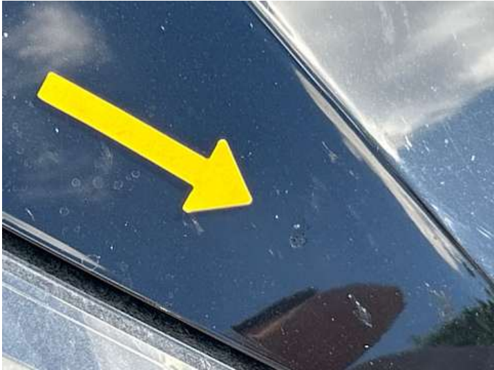
Motorhaube (Steinschlag, Unsachgemäß instand gesetzt)
