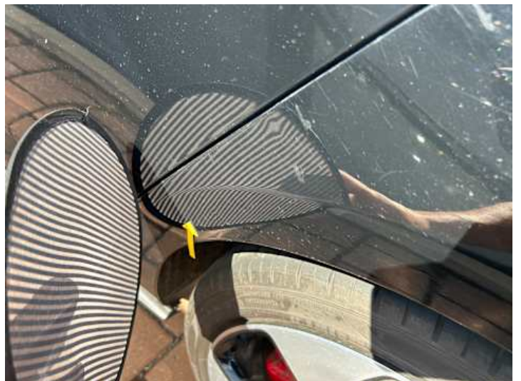
Seitenteil hinten links (Delle, Rost)
