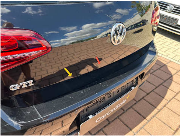
Heckklappe (Kratzer, Unsachgemäß instand gesetzt, Rost)
