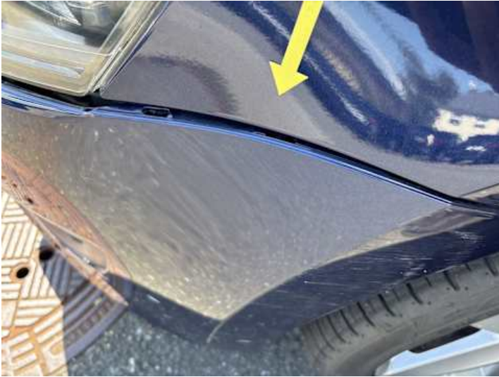
Stoßstange vorne (Spaltmaße ungenau)
