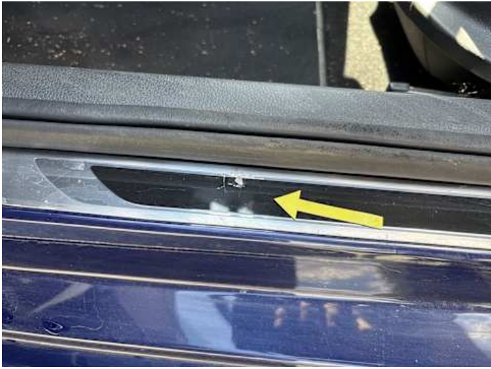
Schweller links (Lackschaden)
