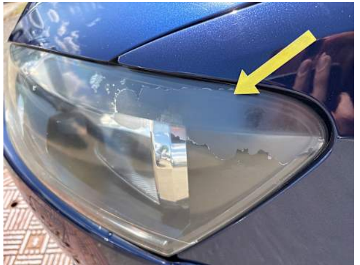
Scheinwerfer (links) (Anderer Schaden): Klarlack löst sich
