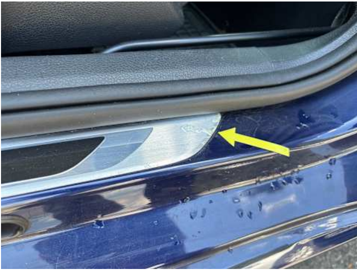
Schweller links (Lackschaden)
