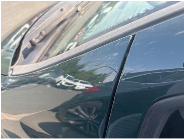
Kotflügel vorne links (Riss/Bruch)
