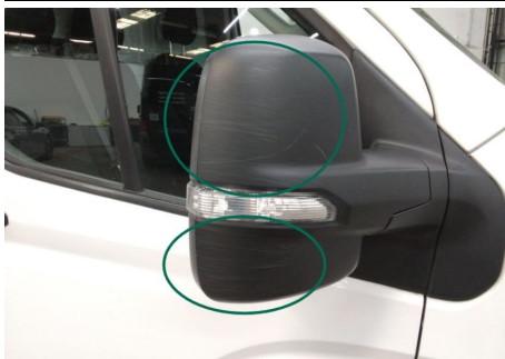
Außenspiegelkappe / Rechts / Kratzer
