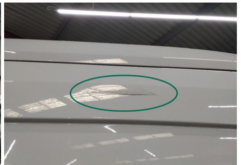
Tür / Oben Rechts / Delle
