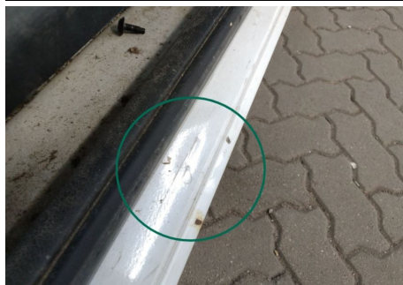
Türeinstieg / Rechts / Delle
