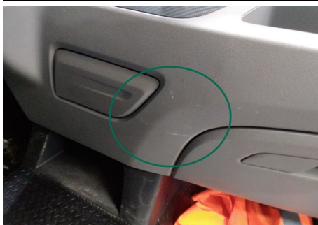
Armaturenbrett / Vorne Rechts / Kratzer
