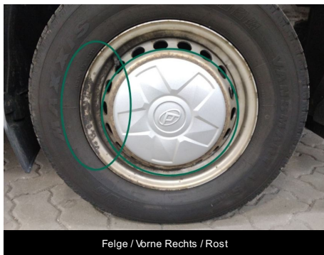
Felge / Vorne Rechts / Rost
