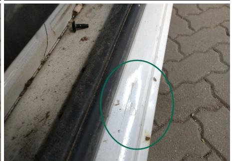
Türeinstieg / Rechts / Delle
