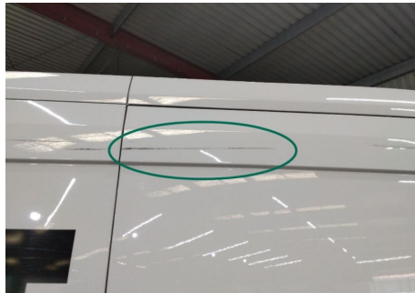
Tür / Oben Rechts / Delle
