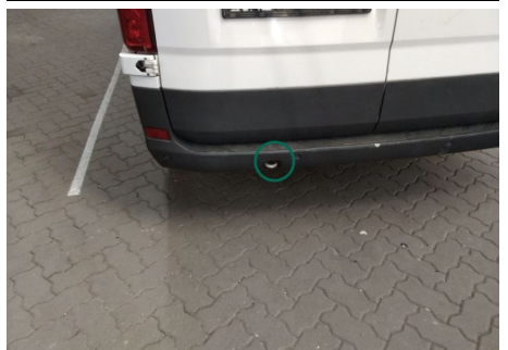
Abdeckung Abschleppöse / Hinten / Fehlt
