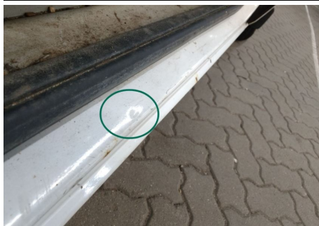
Türeinstieg / Rechts / Delle
