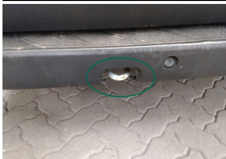
Abdeckung Abschleppöse / Hinten / Fehlt
