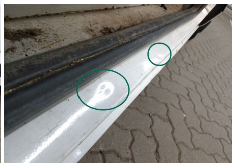
Türeinstieg / Rechts / Delle
