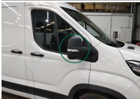
Außenspiegelkappe / Rechts / Kratzer
