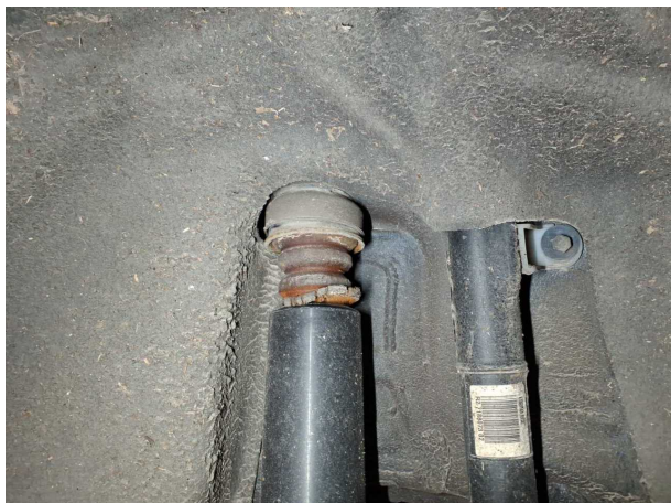
Beschädigung #1: Hinterachse: Stoßdämpfer rechts (Anschlagpuffer) - porös / rissig - erneuern
