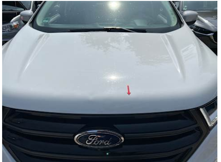
Motorhaube (Lackschaden, Steinschlag)
