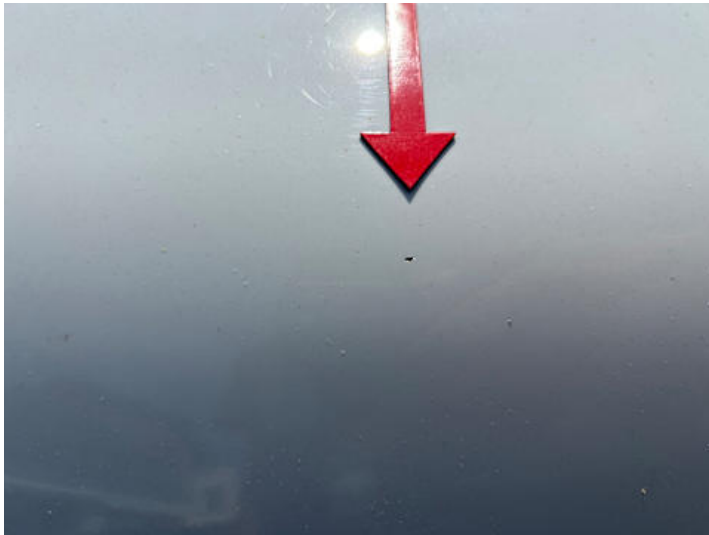
Motorhaube (Lackschaden, Steinschlag)
