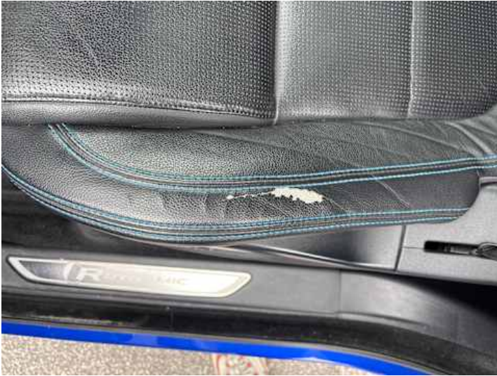
Innenraum (Riss/Bruch, Verschleiß)
