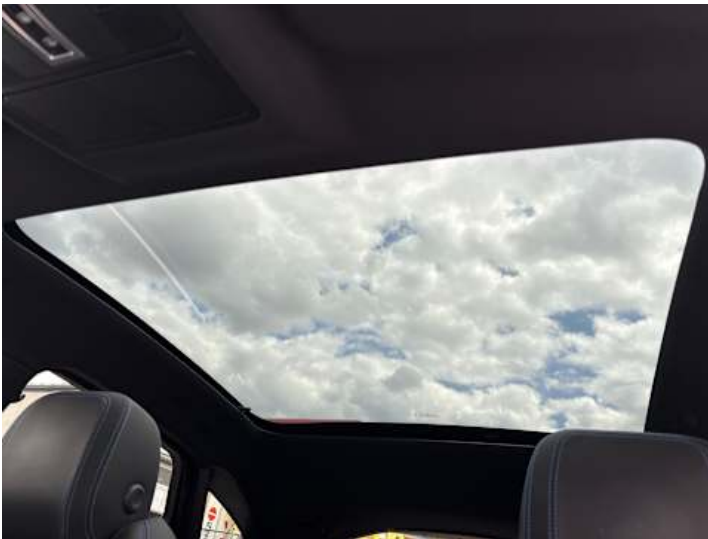
Innenraum (Anderer Schaden): Stoffabdeckung fehlt
