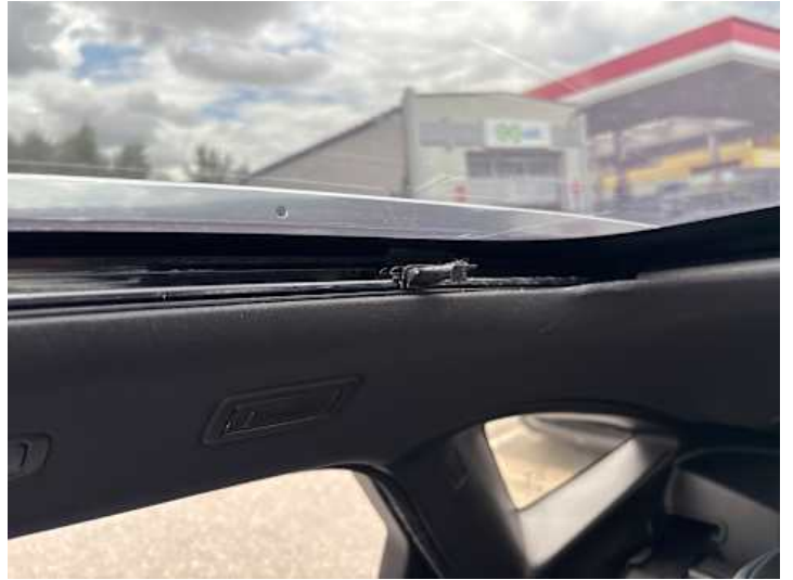
Innenraum (Anderer Schaden): Stoffabdeckung fehlt
