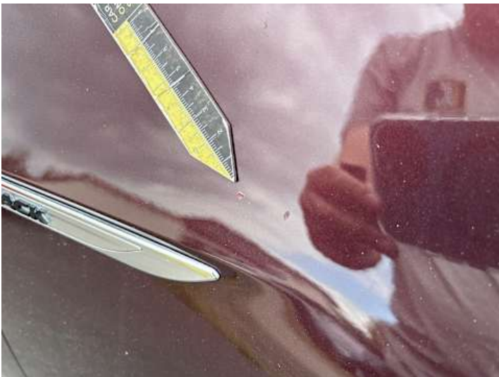
Kotflügel vorne rechts (Steinschlag, Unsachgemäß instand gesetzt)
