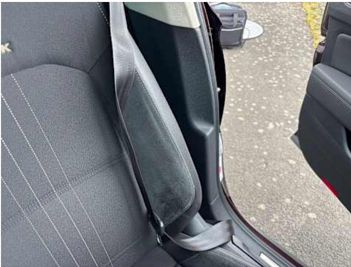
Innenraum (Anderer Schaden): Fahrergurt sehr schwergängig
