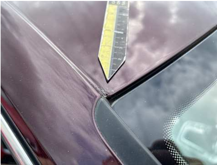
Dach (Lackschaden, Rost)
