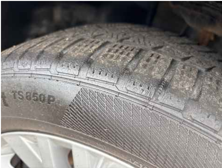
Rad (vehicle.damage-label.porous, Ungleichmäßig abgefahren)
