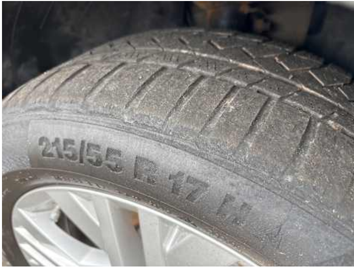
Rad (vehicle.damage-label.porous, Ungleichmäßig abgefahren)
