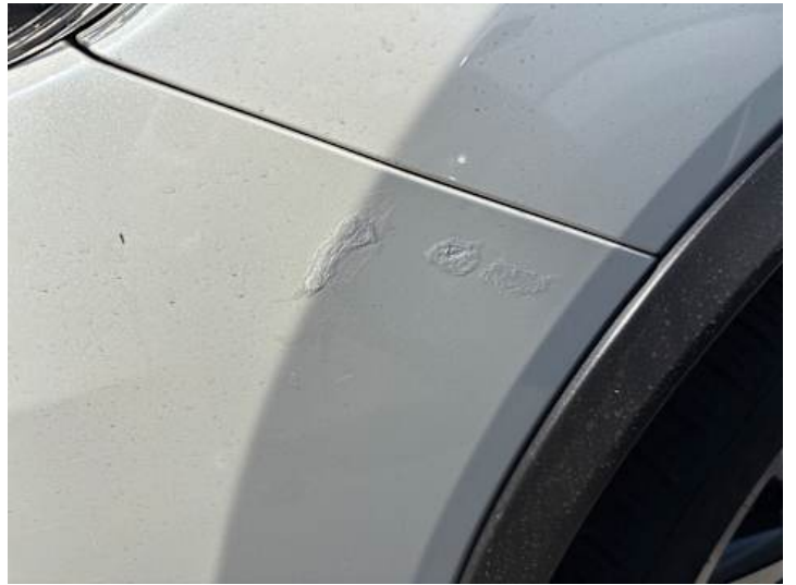
Stoßstange vorne (Unsachgemäß instand gesetzt, Kratzer)
