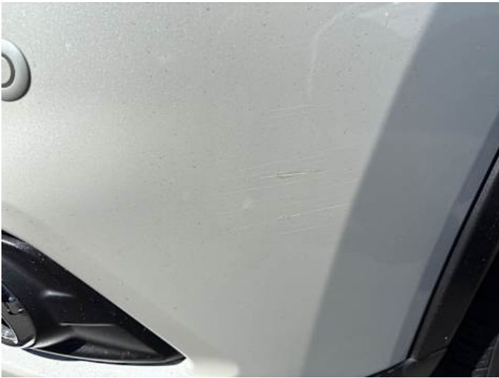
Stoßstange vorne (Unsachgemäß instand gesetzt, Kratzer)
