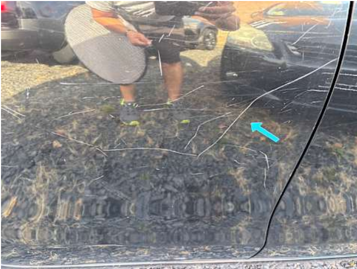
Türe hinten rechts (Kratzer, Lackschaden)
