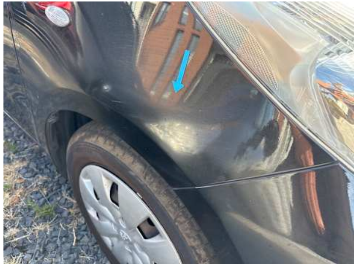
Kotflügel vorne rechts (Unsachgemäß instand gesetzt)
