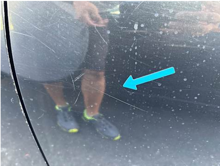
Türe hinten links (Kratzer)
