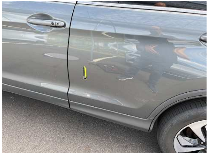
Türe hinten links (Steinschlag)
