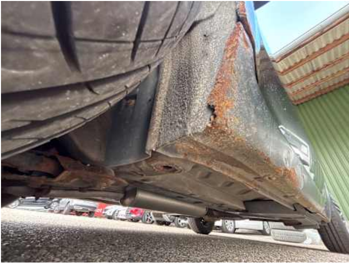
Schweller links (Rost, Verformung)
