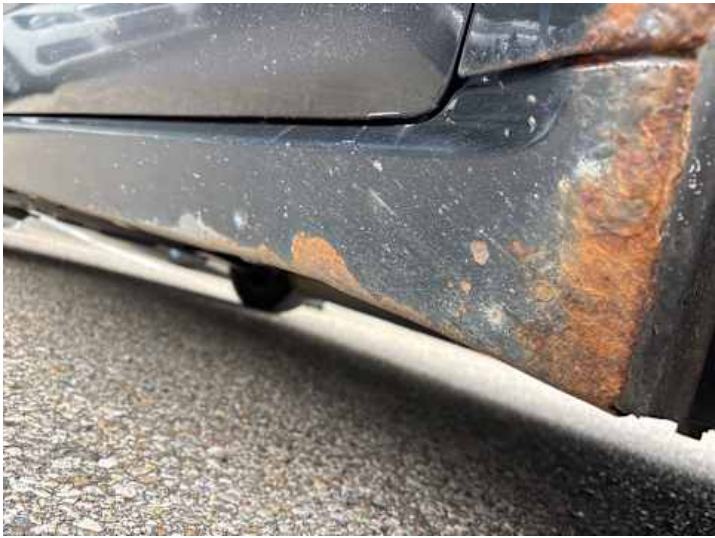
Schweller rechts (Rost)
