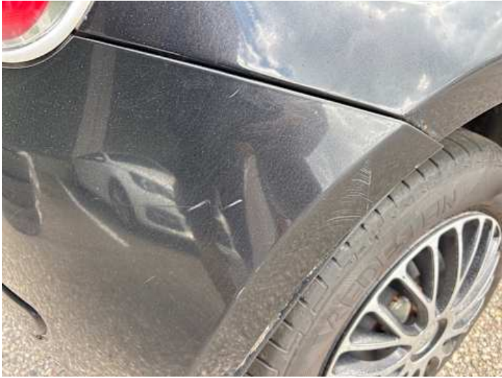
Stoßstange hinten (Spaltmaße ungenau, Kratzer, Verformung)
