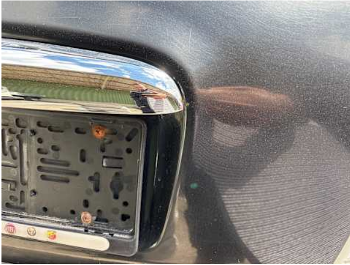
Heckklappe (Rost, Ausgeblichen/Matt)
