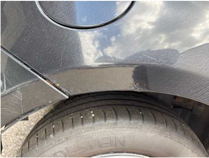
Seitenteil hinten rechts (Steinschlag, Rost)
