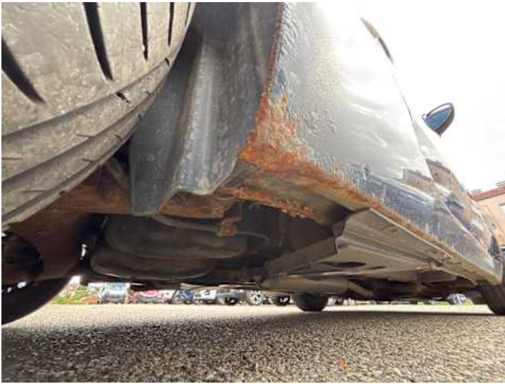
Schweller rechts (Rost)
