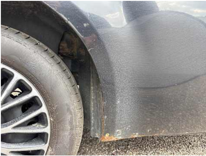
Seitenteil hinten rechts (Steinschlag, Rost)
