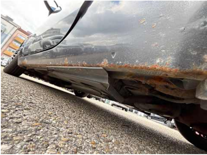
Schweller links (Rost, Verformung)
