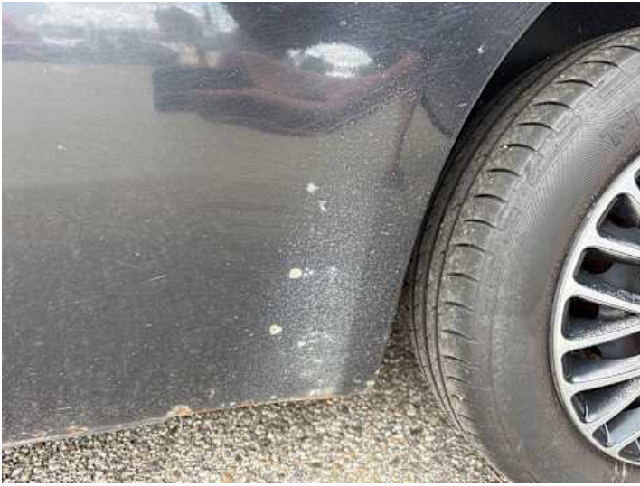
Seitenteil hinten links (Rost, Steinschlag, Lackschaden)
