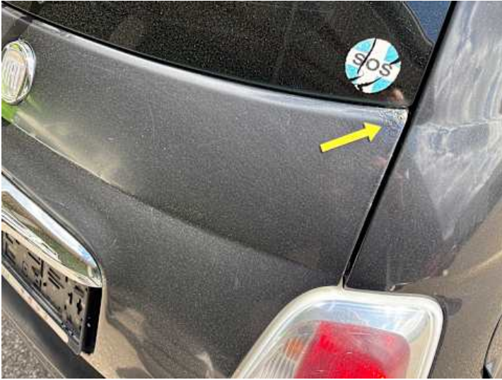
Heckklappe (Rost, Ausgeblichen/Matt)
