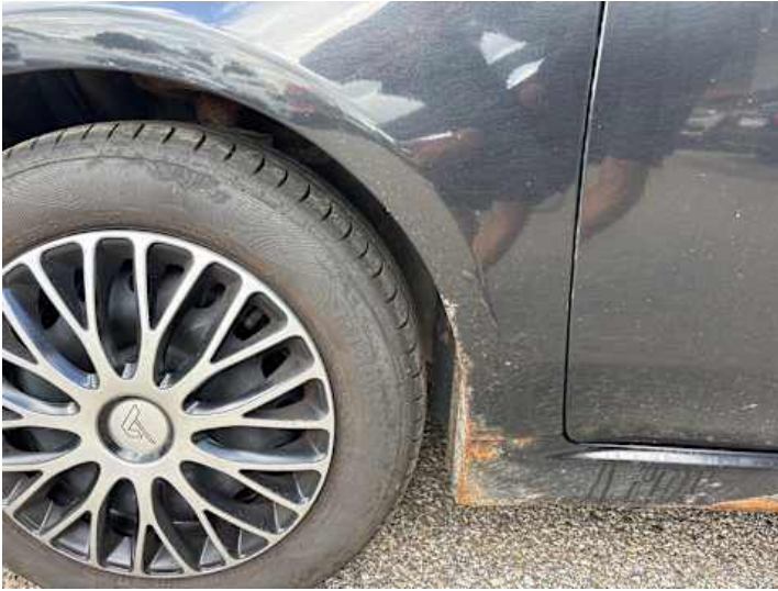
Kotflügel vorne links (Rost)
