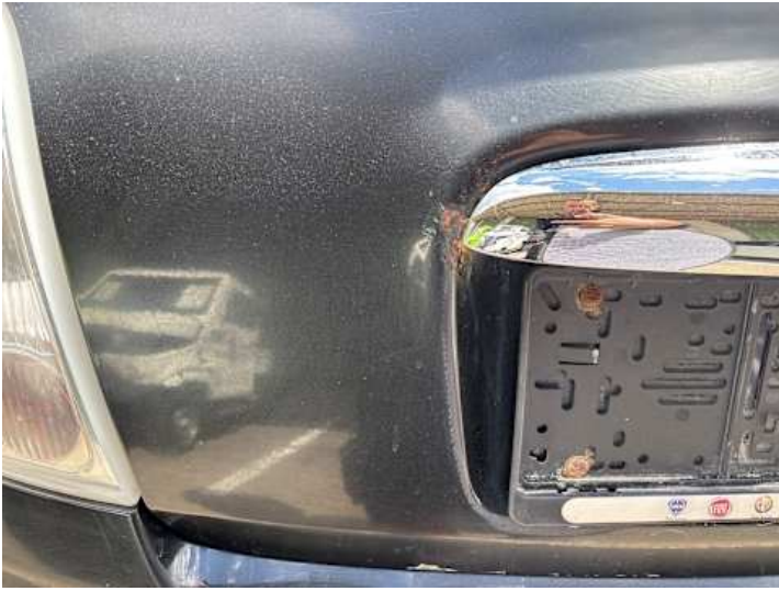
Heckklappe (Rost, Ausgeblichen/Matt)
