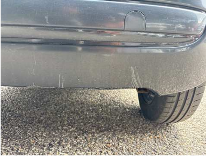
Stoßstange hinten (Spaltmaße ungenau, Kratzer, Verformung)
