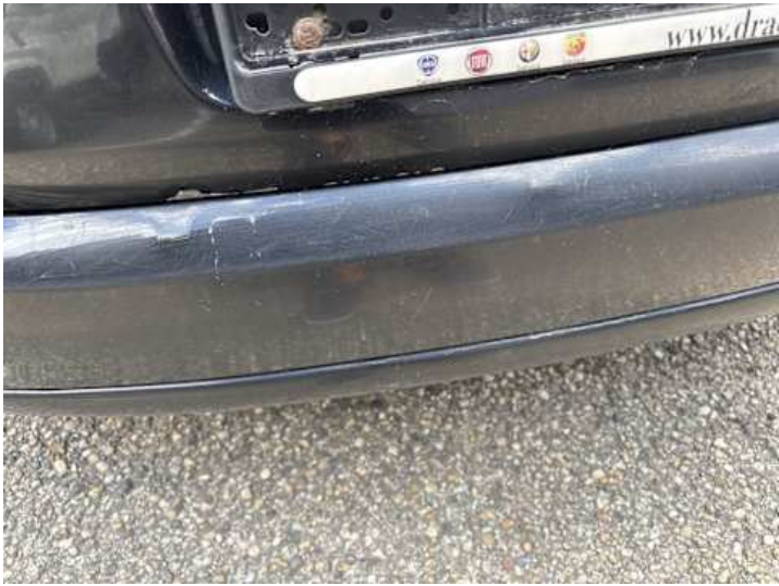
Stoßstange hinten (Spaltmaße ungenau, Kratzer, Verformung)
