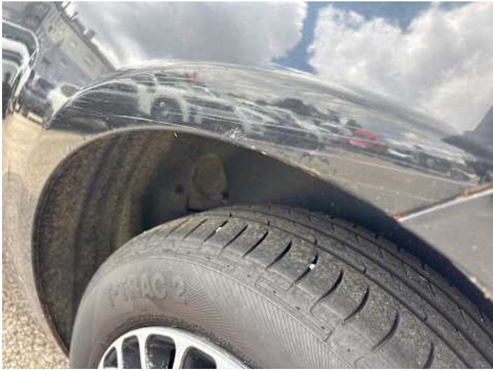
Seitenteil hinten links (Rost, Steinschlag, Lackschaden)
