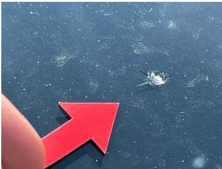
Windschutzscheibe (Riss/Bruch, Steinschlag)
