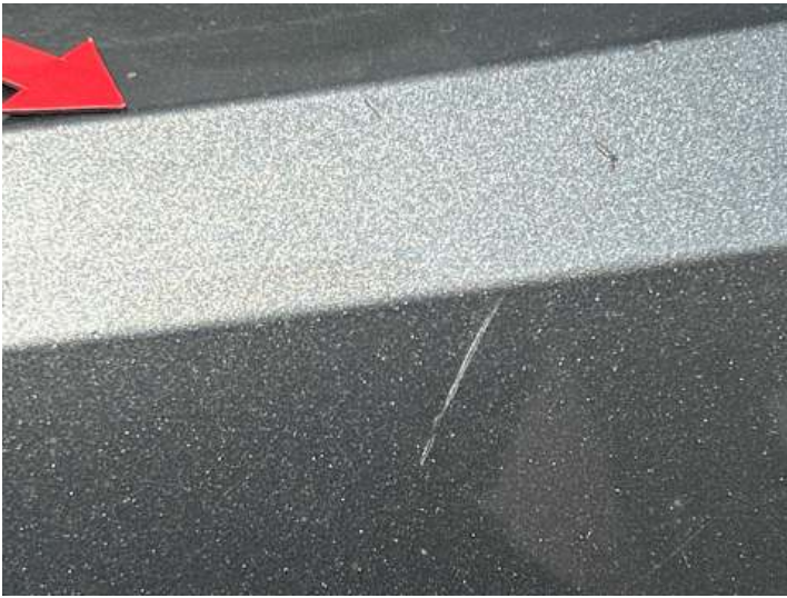
Stoßstange hinten (Kratzer)
