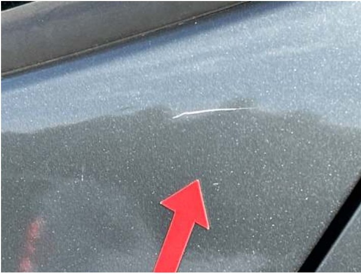
Türe hinten links (Kratzer)
