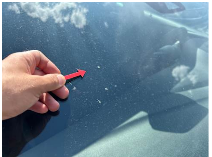
Windschutzscheibe (Riss/Bruch, Steinschlag)
