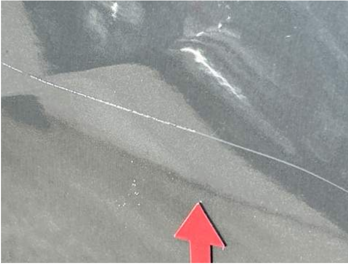
Seitenteil hinten rechts (Kratzer)
