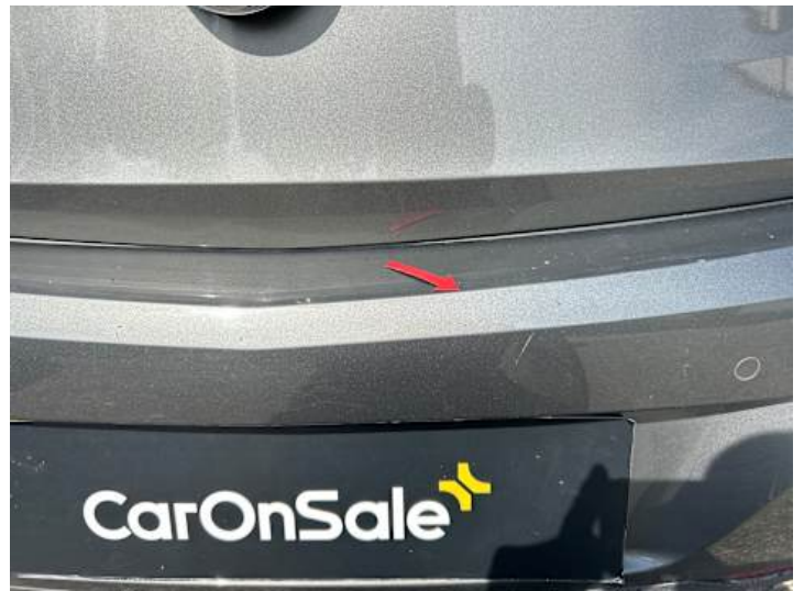
Stoßstange hinten (Kratzer)
