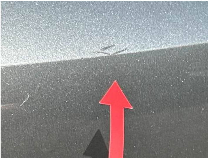
Stoßstange hinten (Kratzer)
