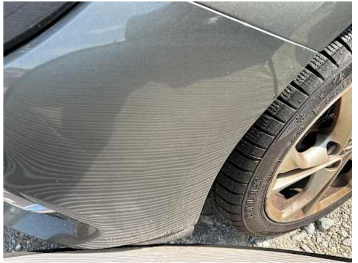
Stoßstange vorne (Verformung)
