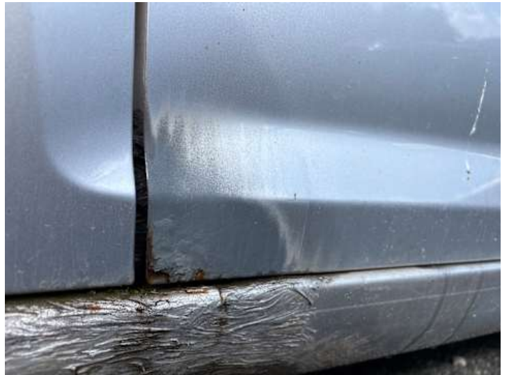
Fahrtür (Rost, Lackschaden)
