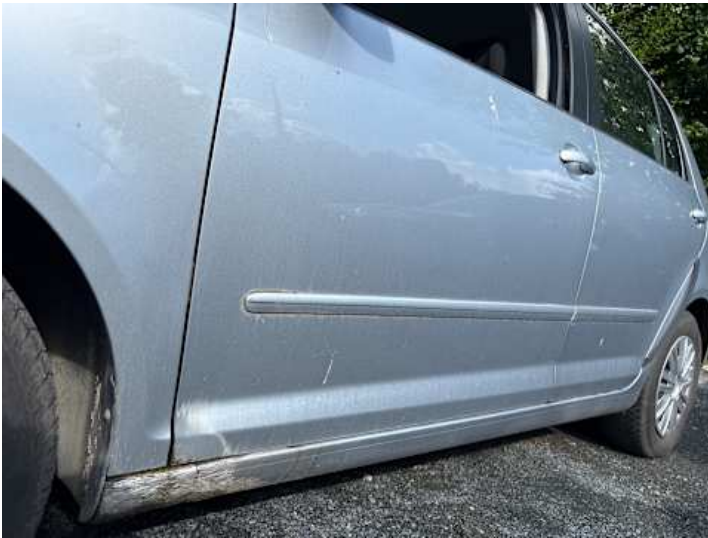
Fahrtür (Rost, Lackschaden)
