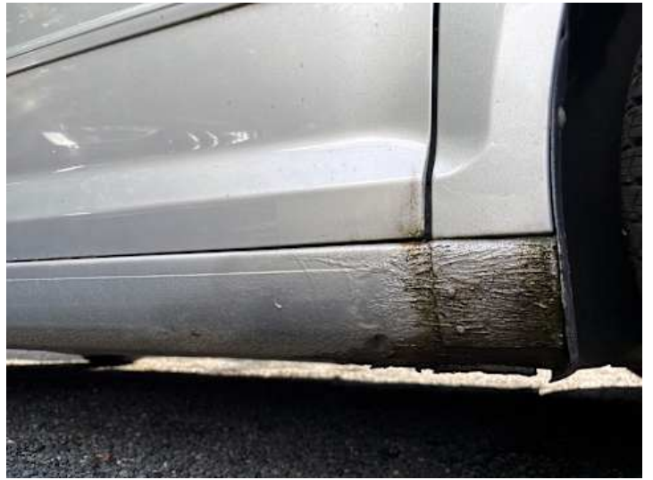
Schweller rechts (Rost, Unsachgemäß instand gesetzt)
