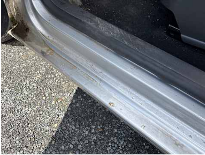
Schweller links (Rost)
