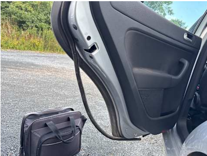
Türe hinten links (Anderer Schaden): Türdichtung Hinten links defekt
