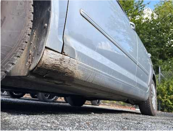
Schweller links (Unsachgemäß instand gesetzt)
