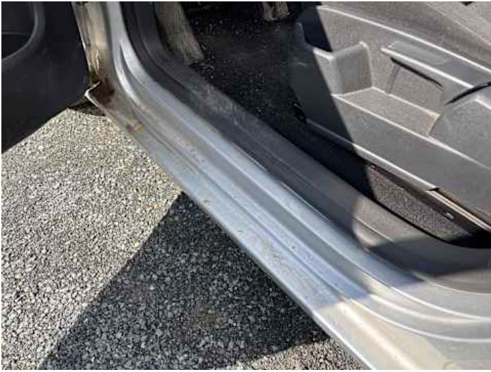
Schweller links (Rost)
