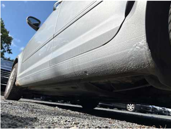
Schweller links (Rost)
