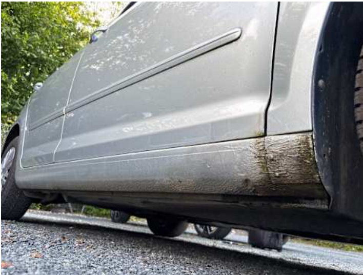
Schweller rechts (Rost, Unsachgemäß instand gesetzt)
