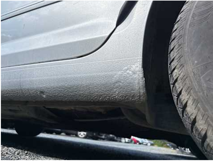
Schweller links (Rost)
