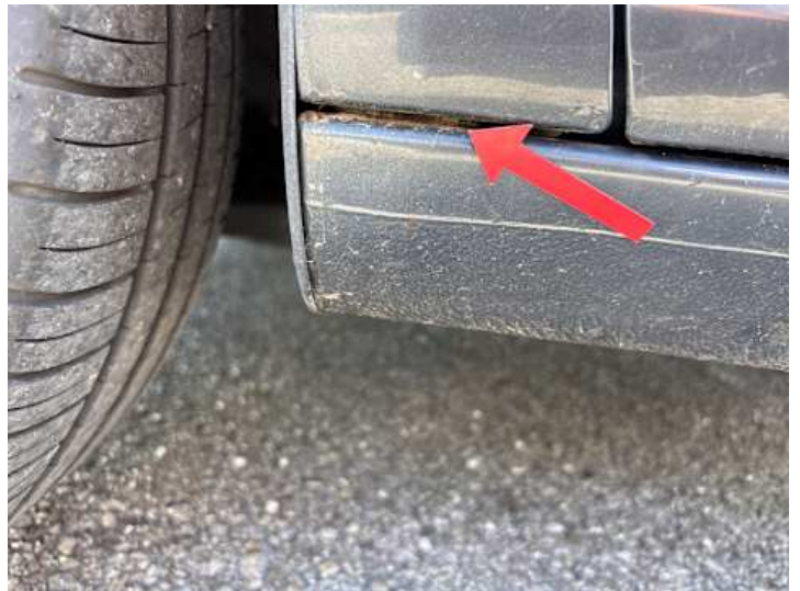
Schweller links (Rost)
