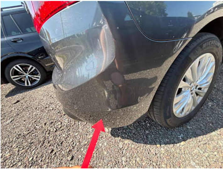
Stoßstange hinten (Kratzer, Verformung)
