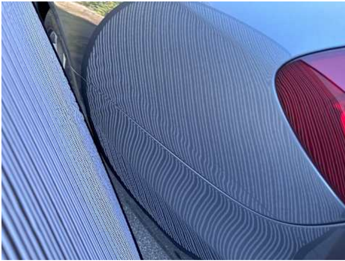
Seitenteil hinten links (Kratzer, Verformung)
