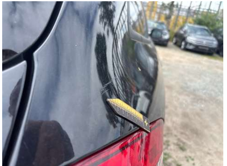
Seitenteil hinten rechts (Kratzer)
