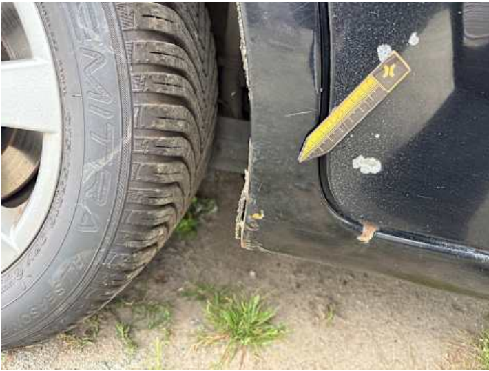
Schweller rechts (Rost)
