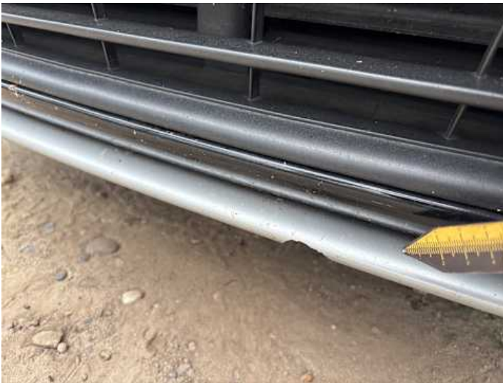
Stoßstange vorne (Riss/Bruch)
