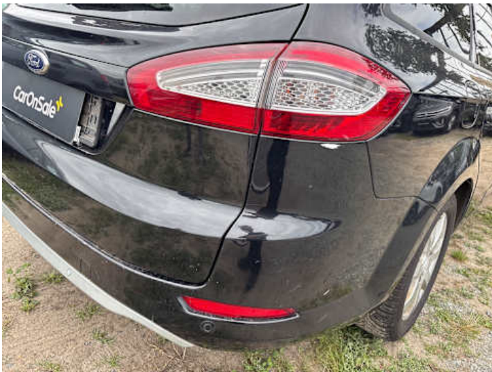
Stoßstange hinten (Kratzer)
