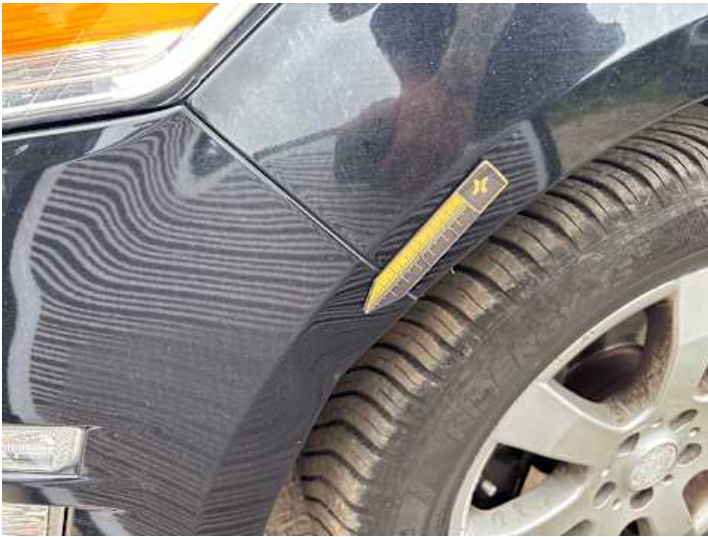
Stoßstange vorne (Verformung)
