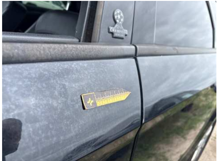
Türe hinten links (Spaltmaße ungenau)
