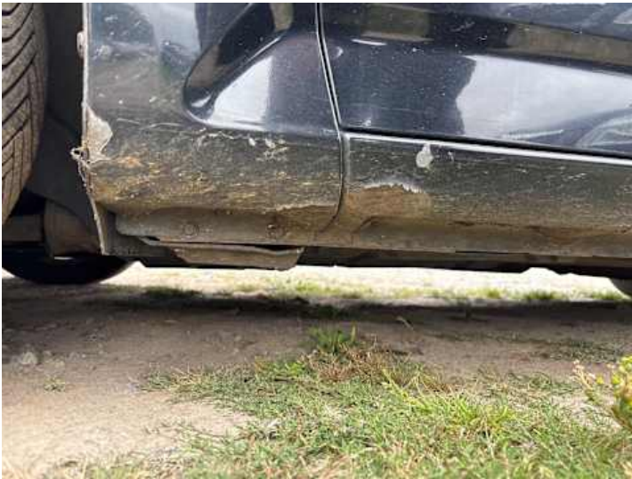
Schweller links (Rost, Lackschaden)
