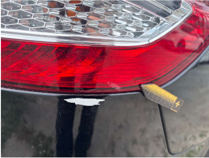
Rücklicht (rechts) (Kratzer)
