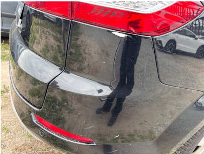
Stoßstange hinten (Kratzer)
