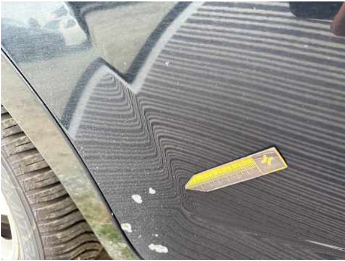
Türe hinten rechts (Lackschaden)
