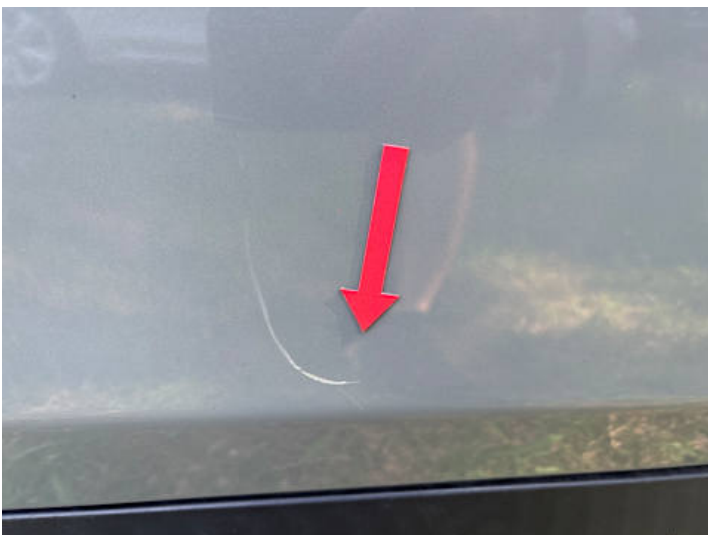
Türe hinten rechts (Lackschaden, Kratzer)
