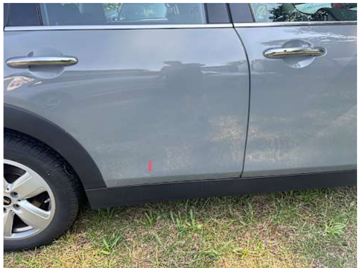
Türe hinten rechts (Lackschaden, Kratzer)
