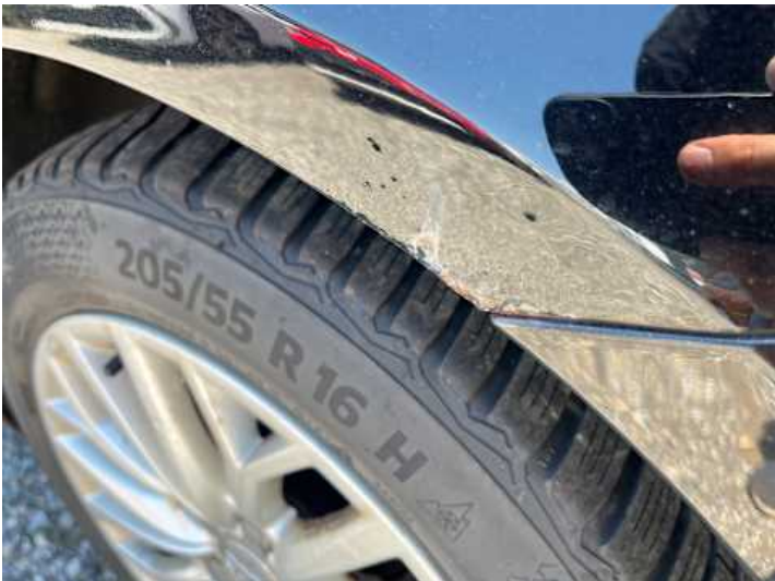
Seitenteil hinten links (Rost)
