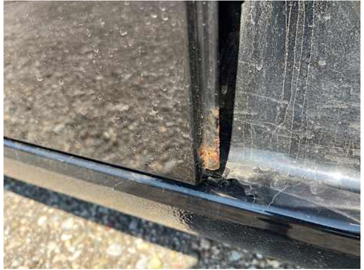
Türe hinten rechts (Rost)
