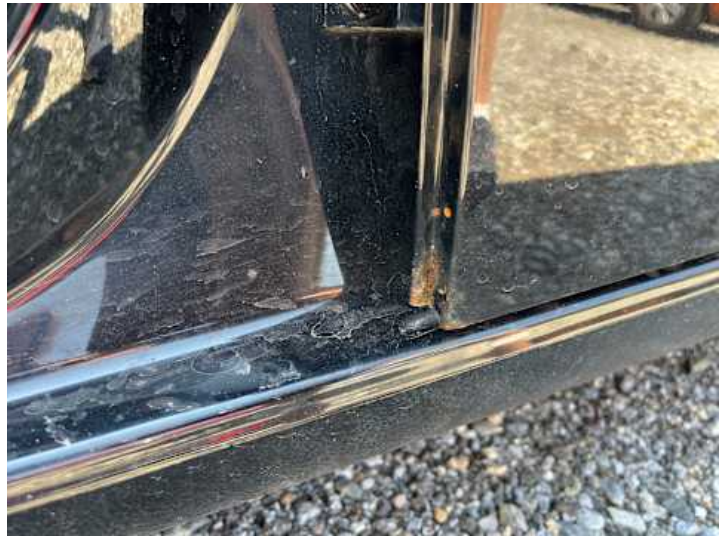
Türe hinten links (Rost)
