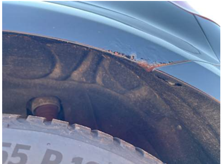
Seitenteil hinten links (Rost)
