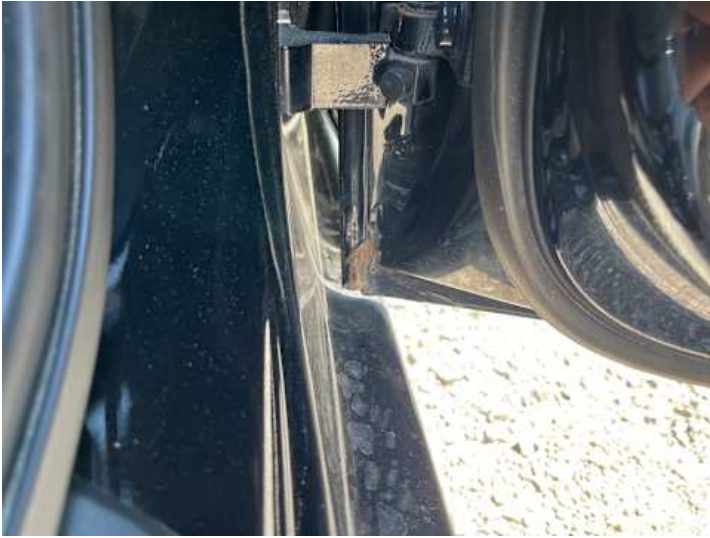
Türe hinten rechts (Rost)
