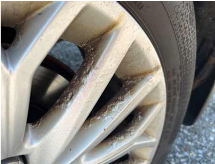
Rad (Kerben, Rost)
