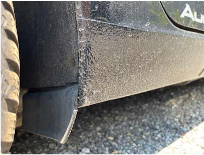
Schweller rechts (Rost)
