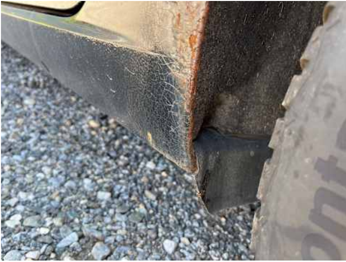
Schweller links (Rost)
