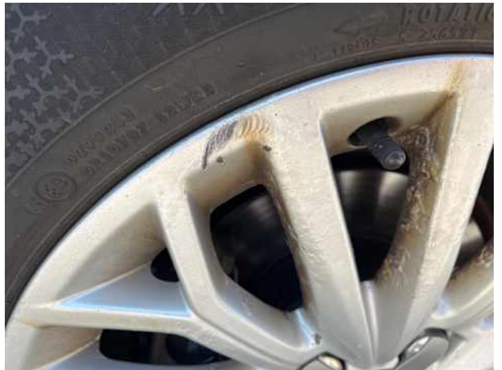
Rad (Kerben, Rost)
