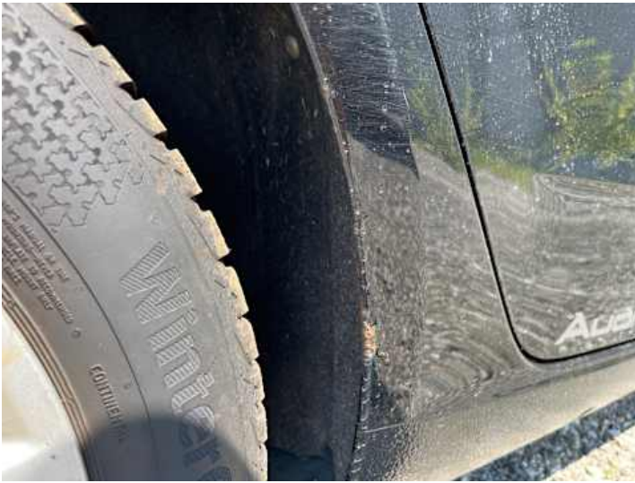
Seitenteil hinten rechts (Rost)
