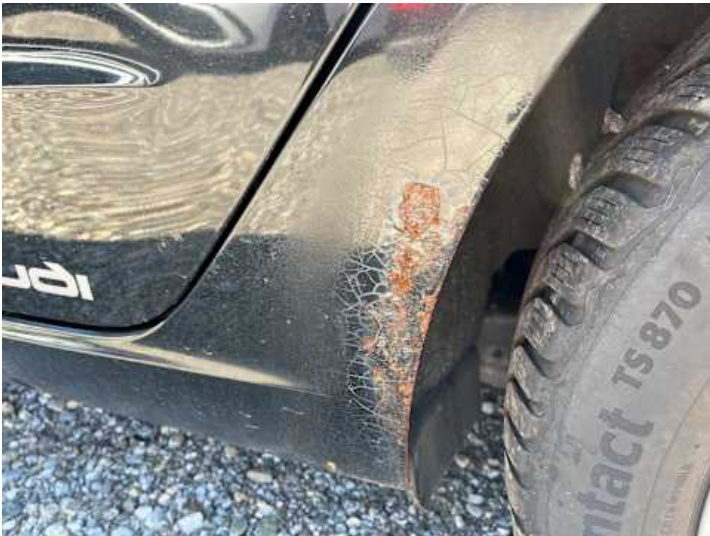
Seitenteil hinten links (Rost)
