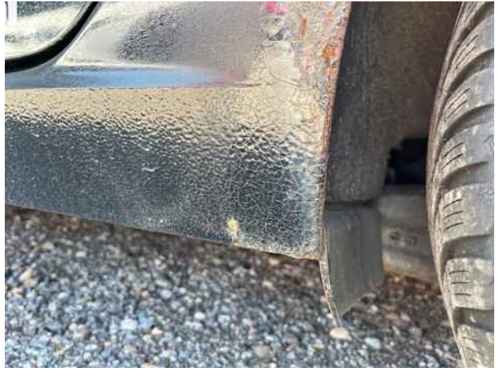
Schweller links (Rost)
