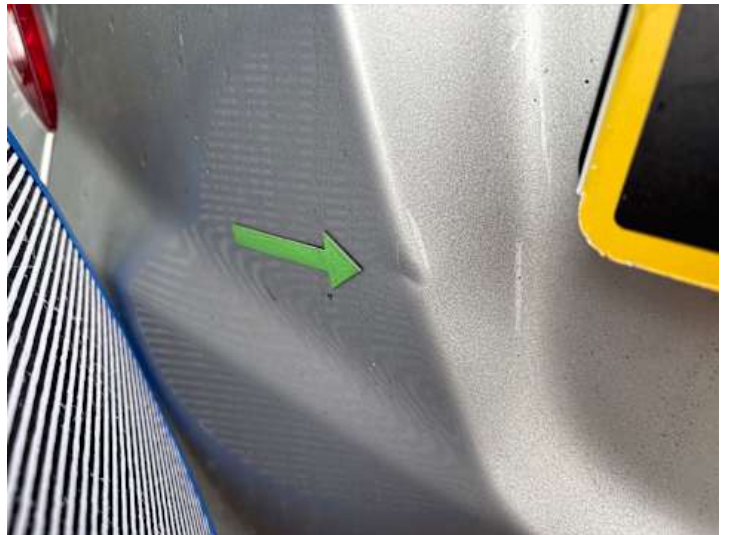
Heckklappe (Verformung, Kratzer)
