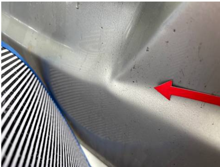
Heckklappe (Verformung, Kratzer)
