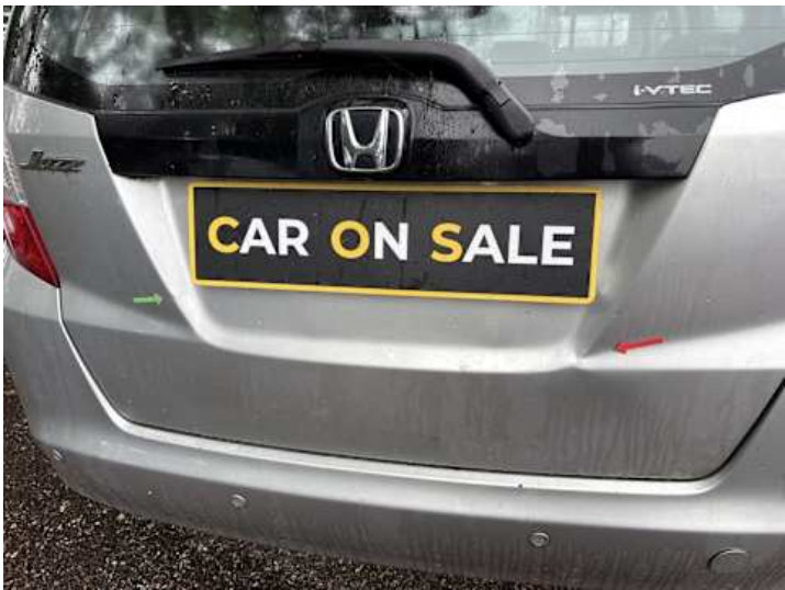
Heckklappe (Verformung, Kratzer)
