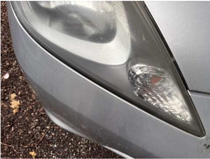
Stoßstange vorne (Spaltmaße ungenau)
