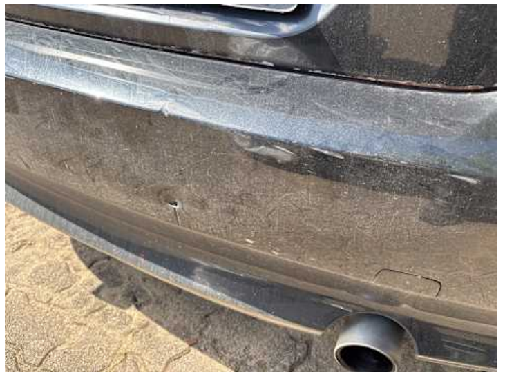
Stoßstange hinten (Spaltmaße ungenau, Lackschaden, Riss/Bruch)
