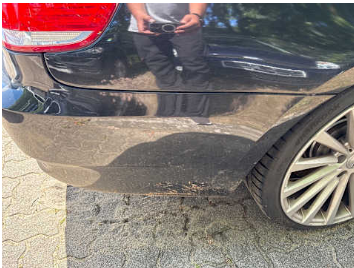
Stoßstange hinten (Spaltmaße ungenau, Lackschaden, Riss/Bruch)
