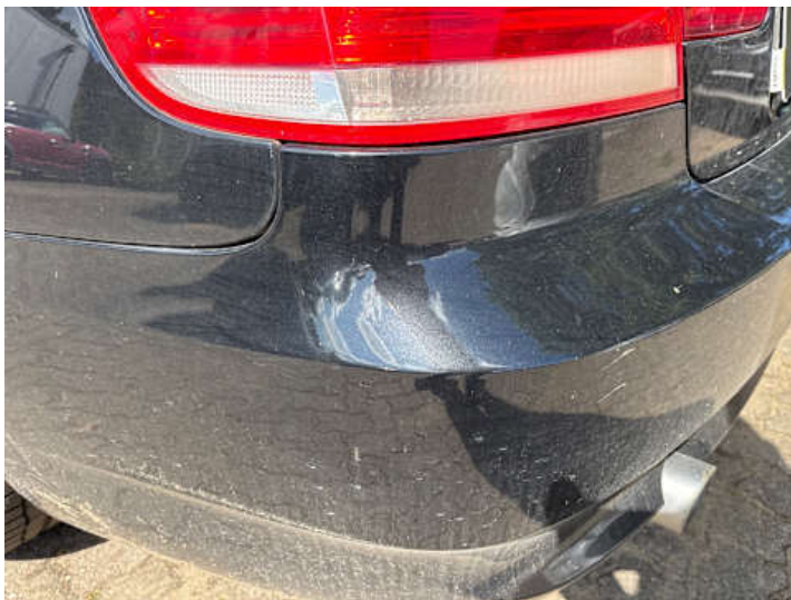
Stoßstange hinten (Spaltmaße ungenau, Lackschaden, Riss/Bruch)
