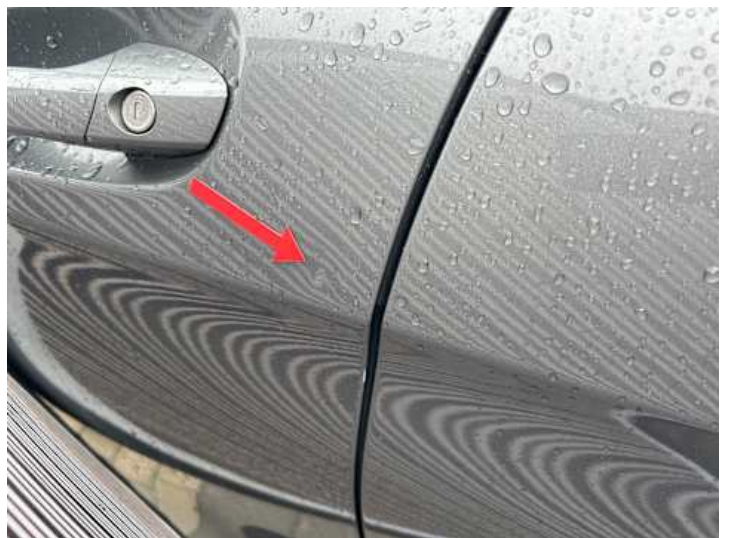
Fahrtür (Delle, Kratzer)
