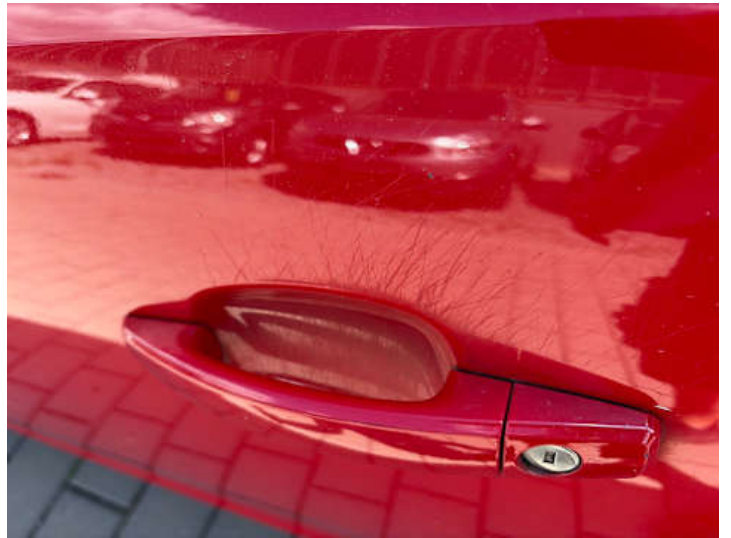
Fahrtür (Kratzer, Delle)
