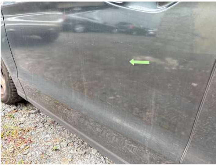
Fahrtür (Lackschaden, Anderer Schaden): Lack matt
