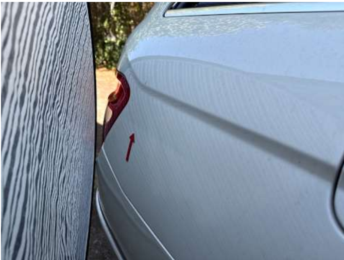
Seitenteil hinten rechts (Verformung)
