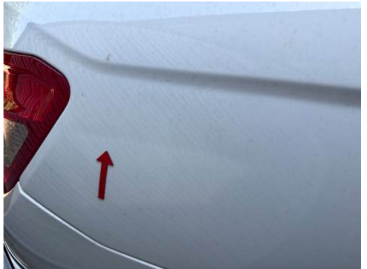
Seitenteil hinten rechts (Verformung)
