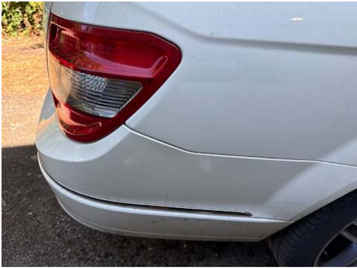
Stoßstange hinten (Spaltmaße ungenau)
