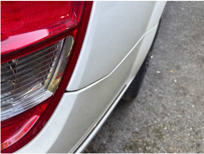
Stoßstange hinten (Spaltmaße ungenau)
