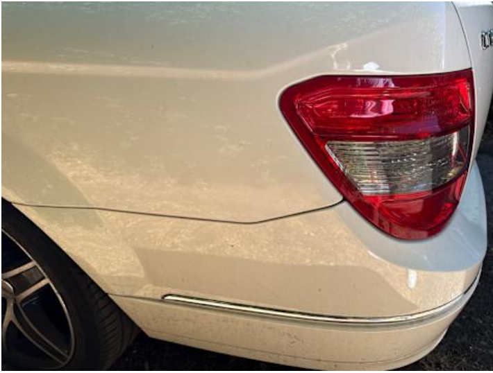
Stoßstange hinten (Spaltmaße ungenau)
