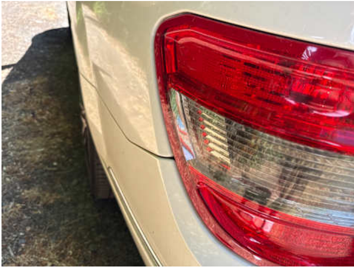
Stoßstange hinten (Spaltmaße ungenau)
