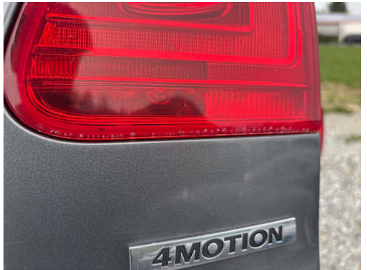
Rücklicht (rechts) (Riss/Bruch)
