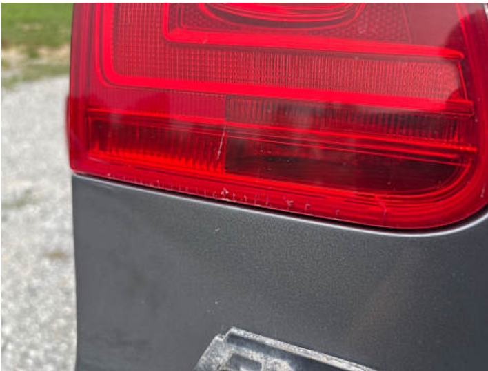
Rücklicht (links) (Riss/Bruch)
