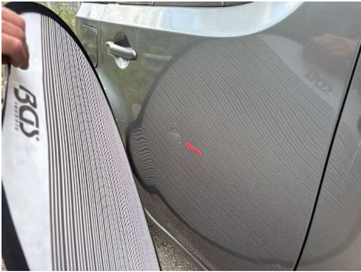
Türe hinten rechts (Delle, Kratzer, Rost)
