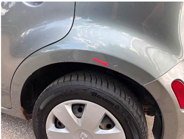
Seitenteil hinten links (Rost)
