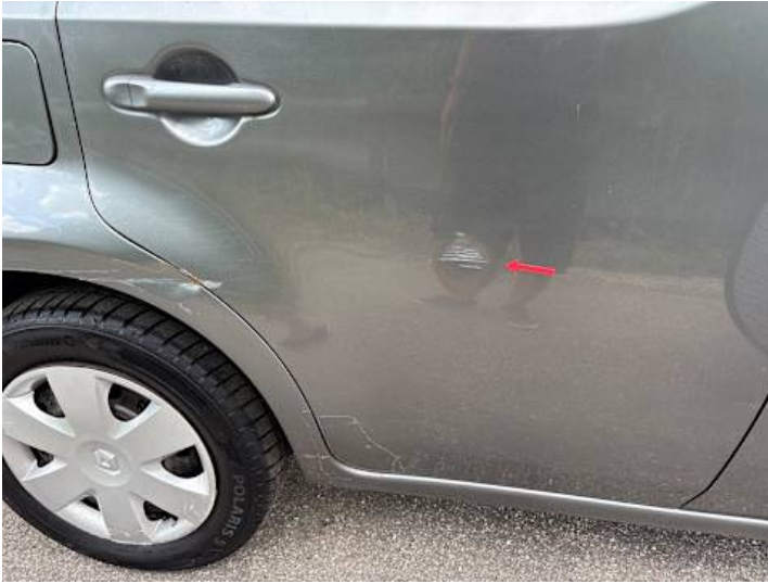
Türe hinten rechts (Delle, Kratzer, Rost)
