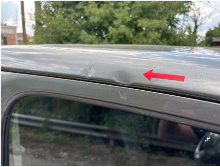
Dach (Delle, Kratzer)
