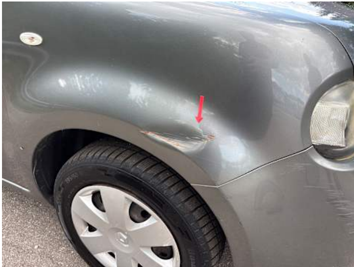
Kotflügel vorne rechts (Verformung, Kratzer, Rost, Lackschaden)
