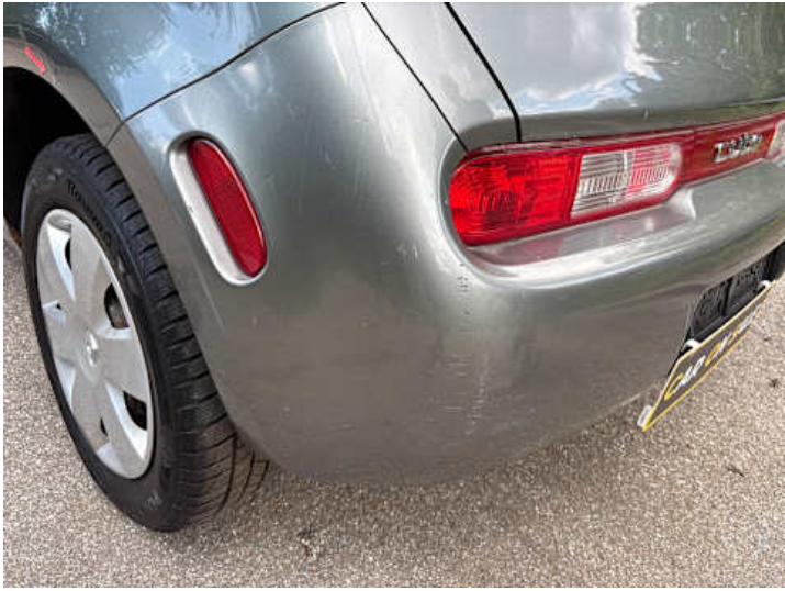
Stoßstange hinten (Kratzer, Lackschaden, Riss/Bruch)
