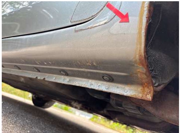
Schweller links (Rost)
