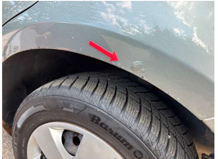
Seitenteil hinten links (Rost)
