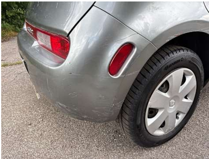
Stoßstange hinten (Kratzer, Lackschaden, Riss/Bruch)
