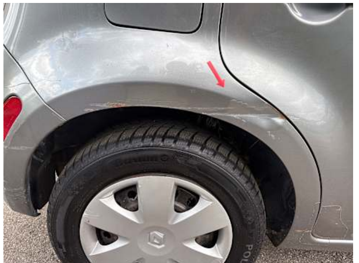
Seitenteil hinten rechts (Verformung, Kratzer, Lackschaden, Rost)
