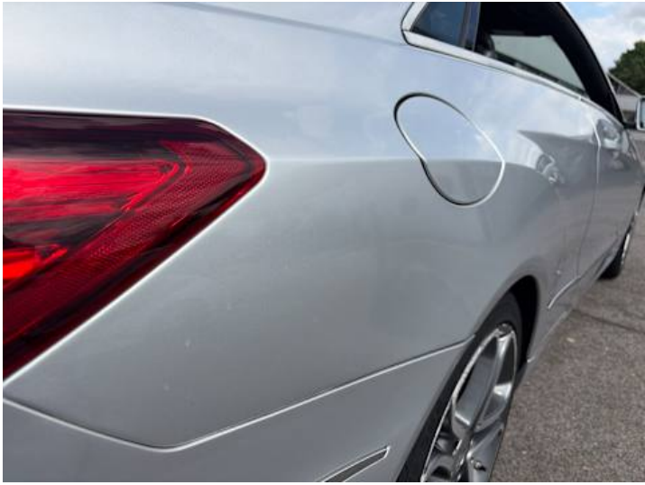
Seitenteil hinten rechts (Unsachgemäß instand gesetzt)
