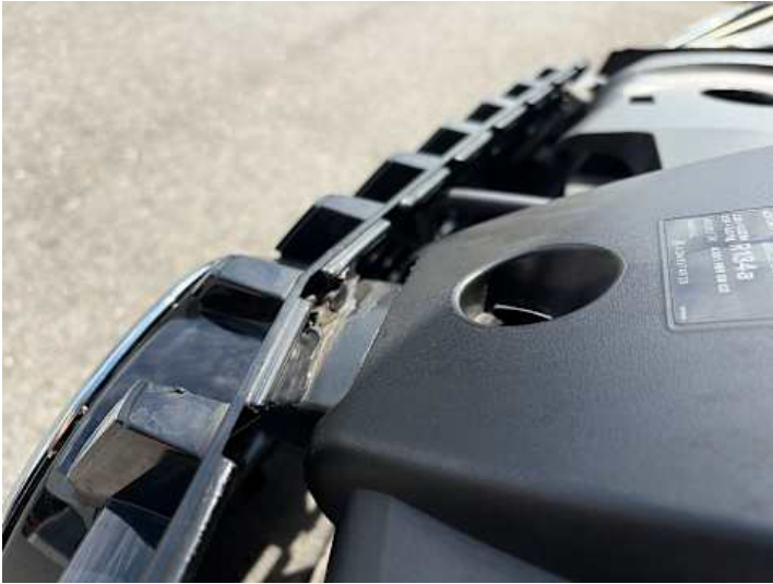
Stoßstange vorne (Riss/Bruch, Unsachgemäß instand gesetzt)
