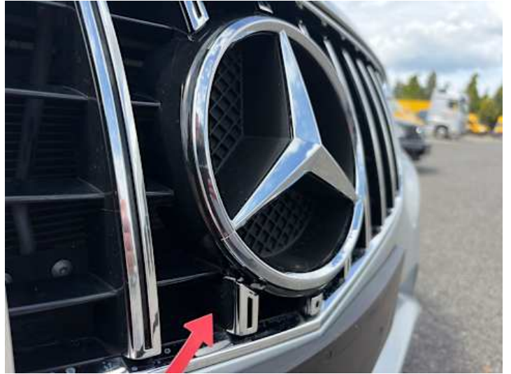
Stoßstange vorne (Riss/Bruch)
