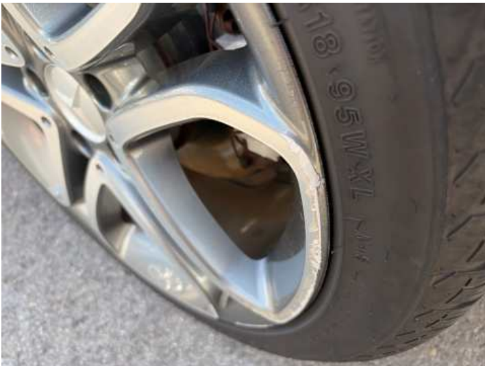
Rad (Kerben, Kratzer, Riss/Bruch)
