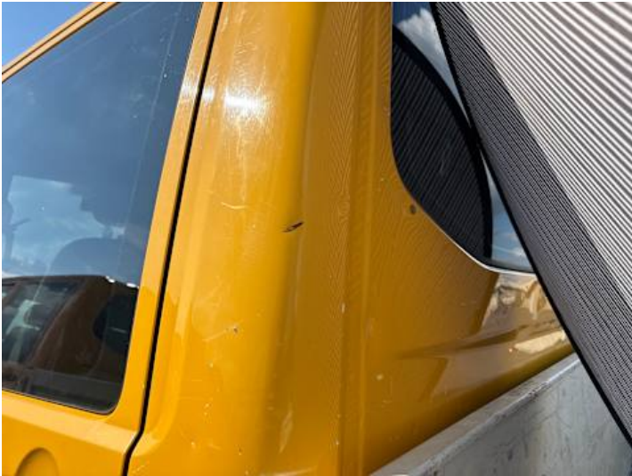
Seitenteil hinten links (Delle, Verformung)
