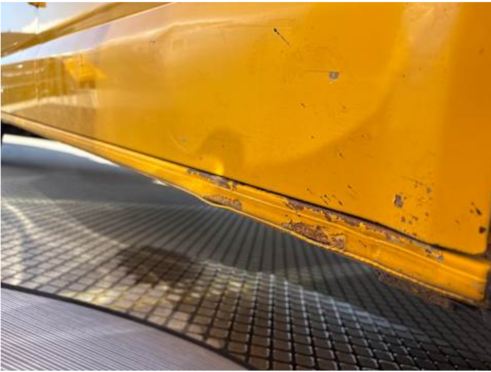
Schweller rechts (Kratzer, Verformung, Rost)
