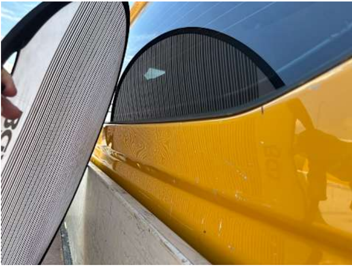
Seitenteil hinten rechts (Delle, Verformung, Kratzer)
