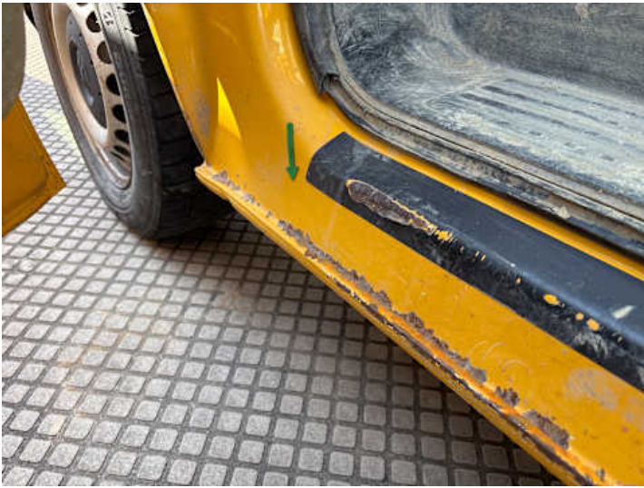
Schweller links (Rost, Lackschaden, Kratzer)
