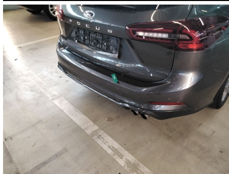
Stoßfänger / Hinten / Gebrochen
