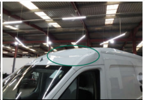
Dach / Vorne / Delle
