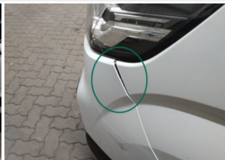
Stoßfängerhalter / Vorne Links / Defekt
