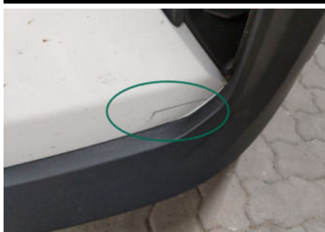
Stoßfänger oberhalb / Vorne / Gebrochen
