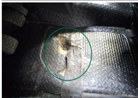
Fußmatten / Vorne Links / Gebrochen
