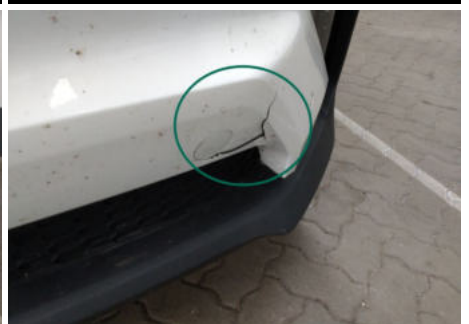
Stoßfänger oberhalb / Vorne / Gebrochen
