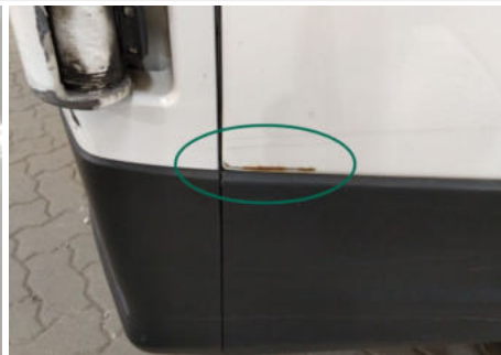
Seitenwand / Unten Rechts / Delle
