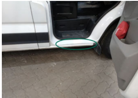
Türeinstieg / Vorne Rechts / Abgewetzt
