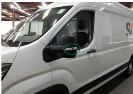
Blinker / Links / Gebrochen
