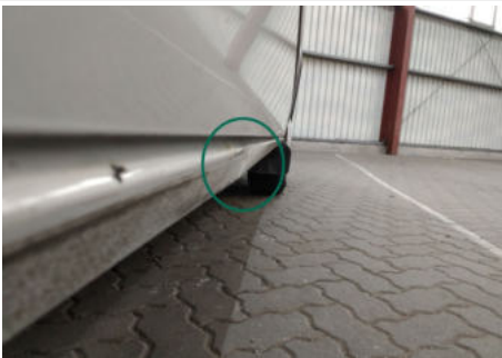
Schweller / Rechts / Delle
