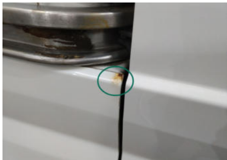
Seitenwand / Unten Rechts / Delle
