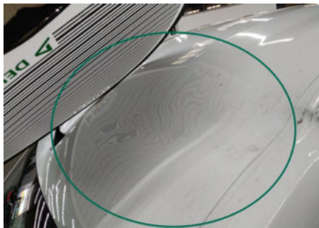
Dach / Vorne / Delle
