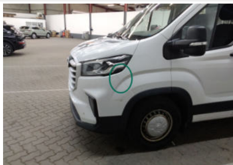
Stoßfängerhalter / Vorne Links / Defekt
