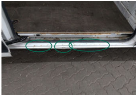
Schweller / Rechts / Delle
