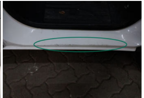
Türeinstieg / Vorne Rechts / Abgewetzt
