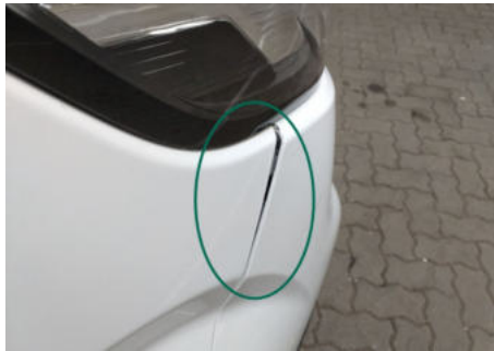
Stoßfängerhalter / Vorne Rechts / Defekt
