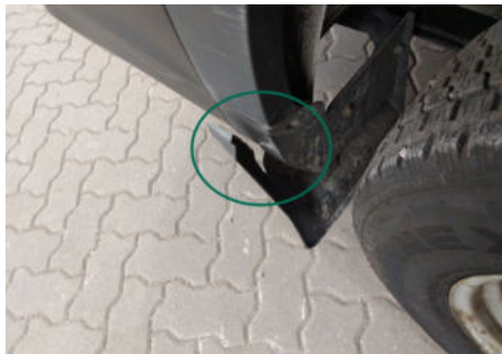
Spritzschutz / Hinten Rechts / Gebrochen
