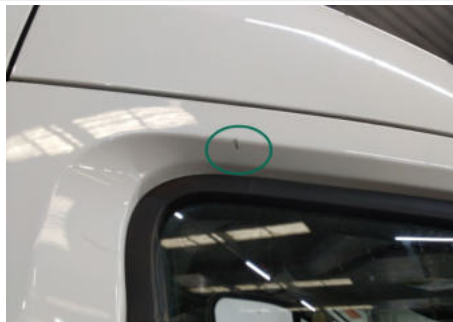
Tür / Oben Vorne Rechts / Kratzer
