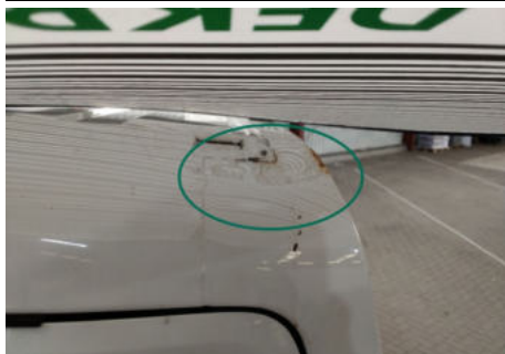
Säule / Hinten Rechts / Delle
