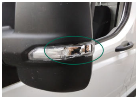
Blinker / Links / Gebrochen
