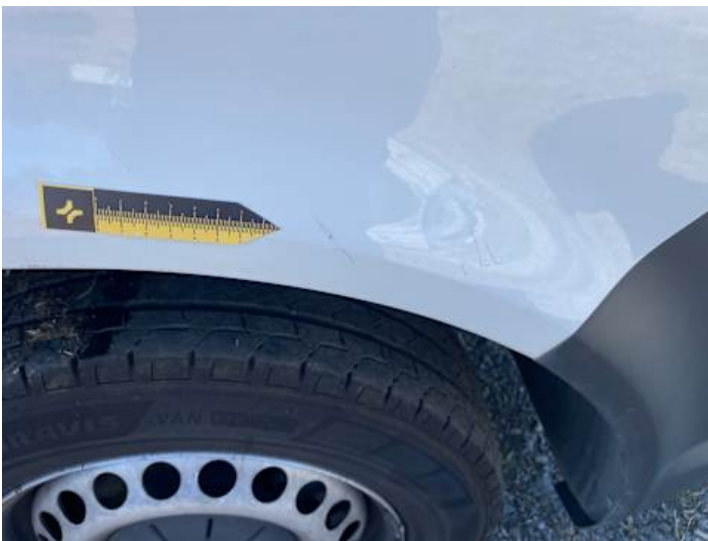
Kotflügel vorne rechts (Kratzer)
