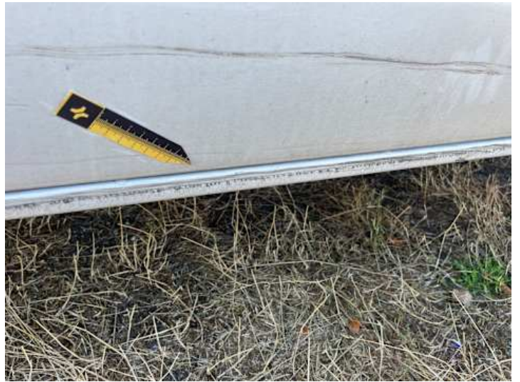
Schweller rechts (Verformung)
